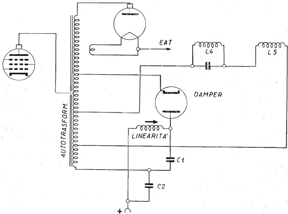
Fig. 10.12 B. - Altro esempio di diodo smorzatore, simile a quello illustrato dalla fig. 12 A. In questo esempio vi è un autotrasformatore. Data la presenza dell'autotrasformatore, le polarità risultano invertite, per cui è invertito anche il diodo smorzatore, diodo damper.
