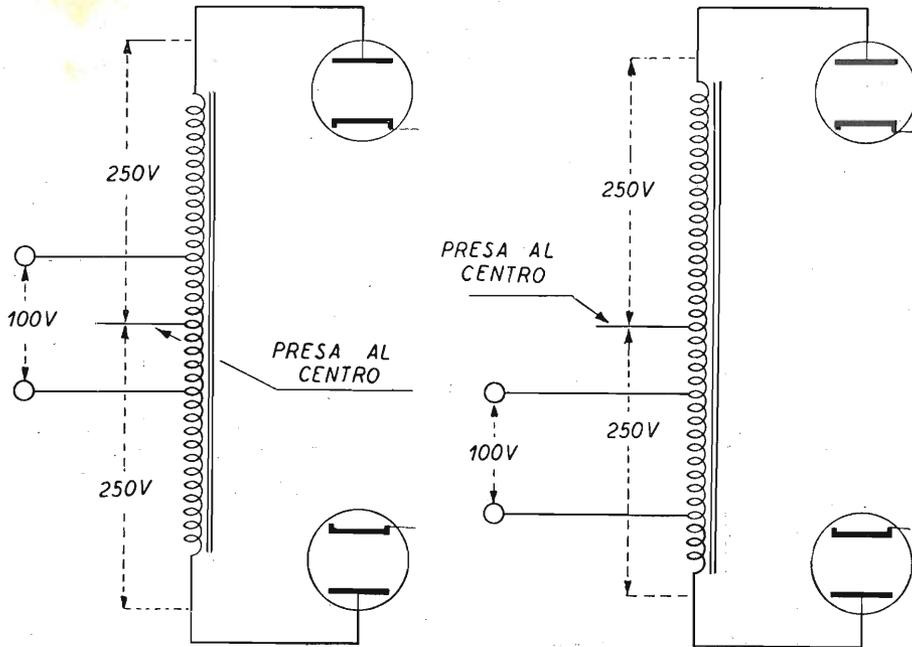
Fig. 12.5. - Principio dell'autotrasformatore con presa al centro.
