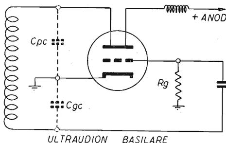
Fig. 14.11. - Oscillatore UHF del tipo ultraudion.
