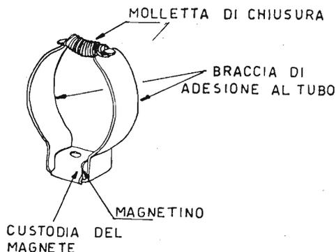
Fig. 4.18 a. - Caratteristiche del magnete della trappola ionica.
