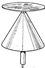
Fig. 17.39. - Le tre versioni del dipolo a cono.
