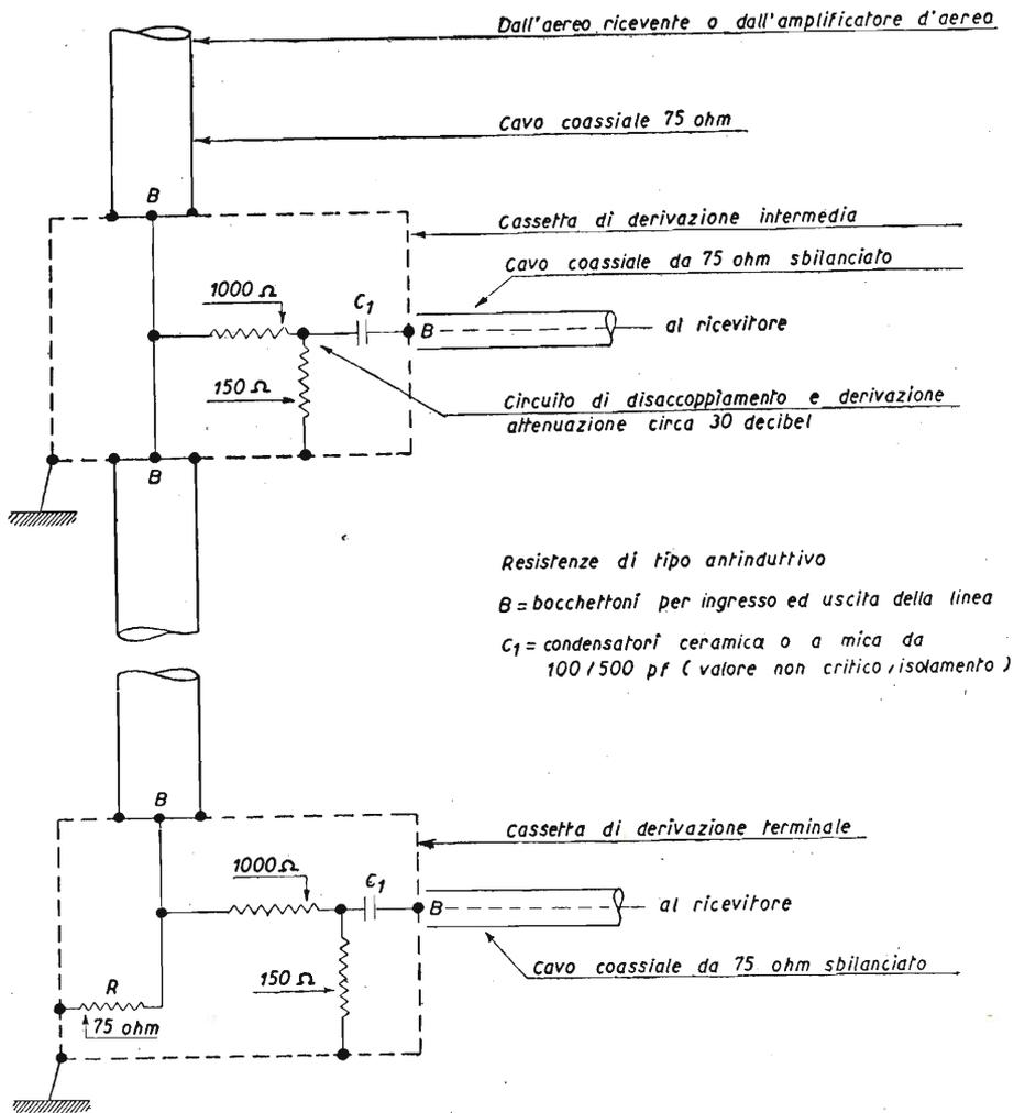
Il cavo va terminato sulla resistenza R di tipo antinduttivo e di valore uguale alla impedenza caratteristica del cavo per la frequenza di lavoro.
