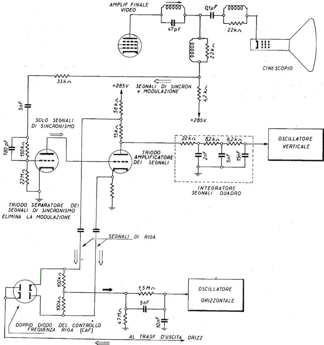
Fig. 13.2. - Schema di principio dei circuiti di sincronismi e dei circuiti di controllo automatico di frequenza, del tipo a discriminatore, con un doppio diodo e un doppio triodo.
