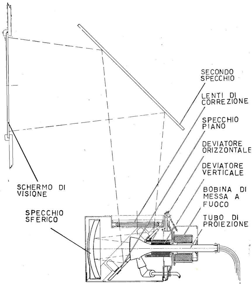
Fig. 15.6. - TV a proiezione. Principio degli apparecchi riceventi di televisione a proiezione sistema North American Philips. Il proiettore TV ha il vantaggio di essere di dimensioni ridotte. Il sistema ottico è lo Schmidt piegato. Il tubo proiettore è piccolissimo, con schermo di 6,35 cm.
