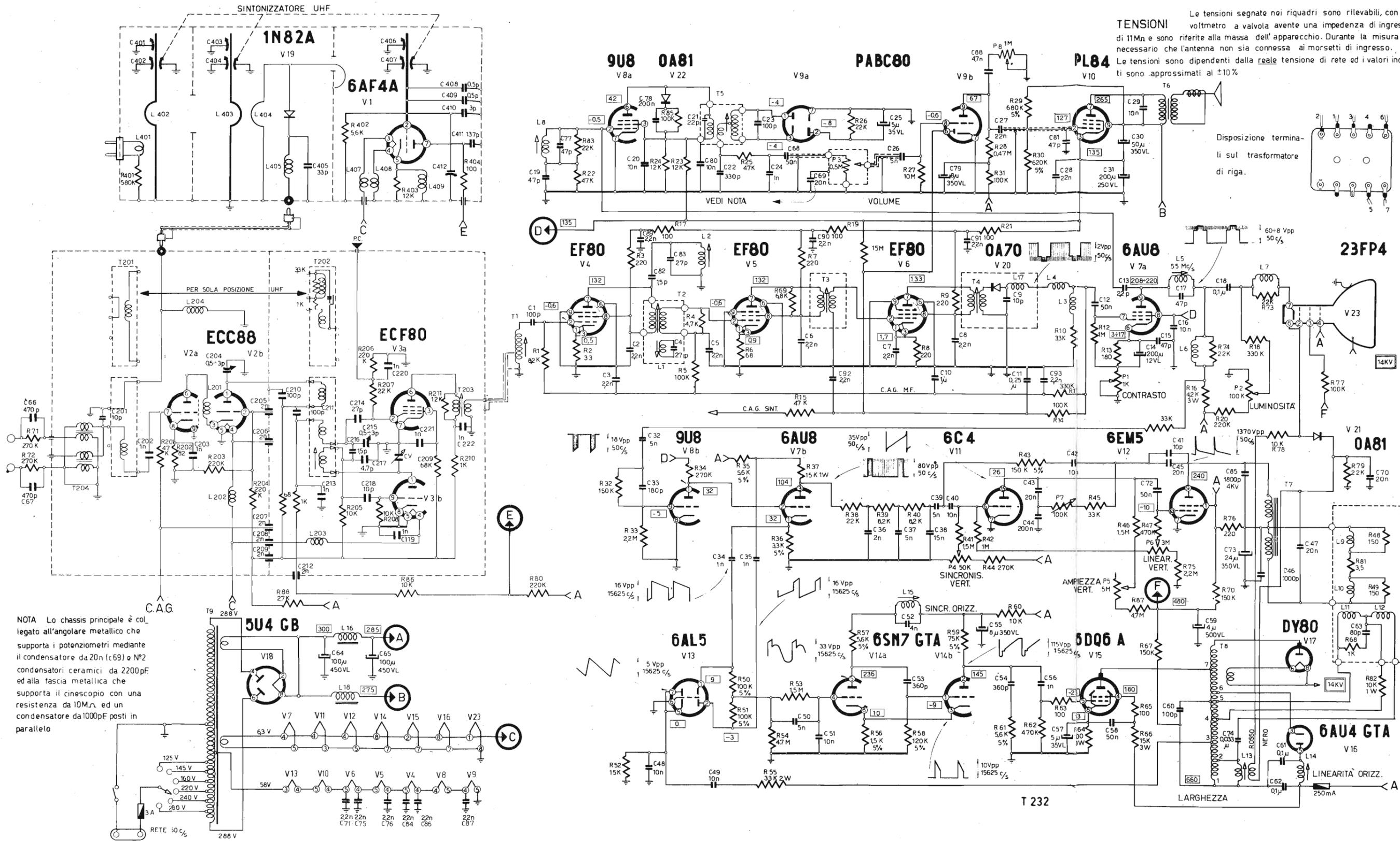
NOTA Lo chassis principale è collegato all'angolare metallico che supporta i potenziometri mediante il condensatore da 20n (c69) e N°2 condensatori ceramici da 2200pF ed alla fascia metallica che supporta il cinescopio con una resistenza da 10MΩ ed un condensatore da 1000pF posti in parallelo
