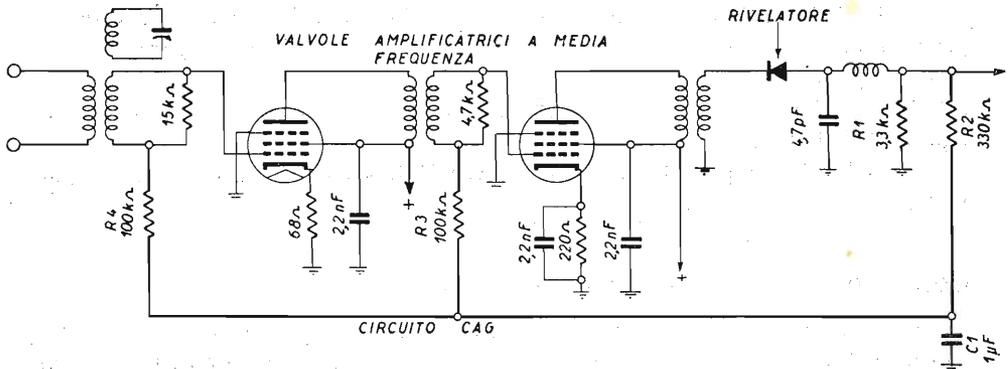
Fig. 7.44. - Principio del controllo automatico di guadagno (CAG).
