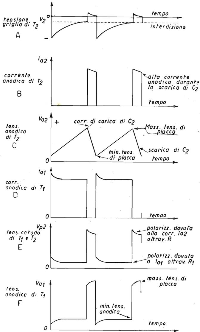
Fig. 8.13. - Grafico di funzionamento di oscillatore a multivibratore.
