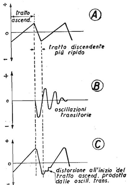
Fig. 10.10 - La rapida caduta di corrente alla fine di ciascun dente di sega produce oscillazioni transitorie.
