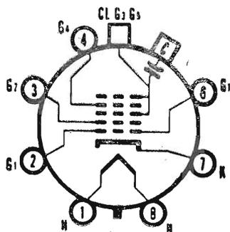
Tubo a visione diretta, con schermo rettangolare a superficie sferica, provvisto di pannello protettivo. Schermo alluminato. Vetro grigio. Focalizzazione elettrostatica. Cannone diritto senza trappola ionica. Rivestimento conduttivo esterno. Fluorescenza bianca.
