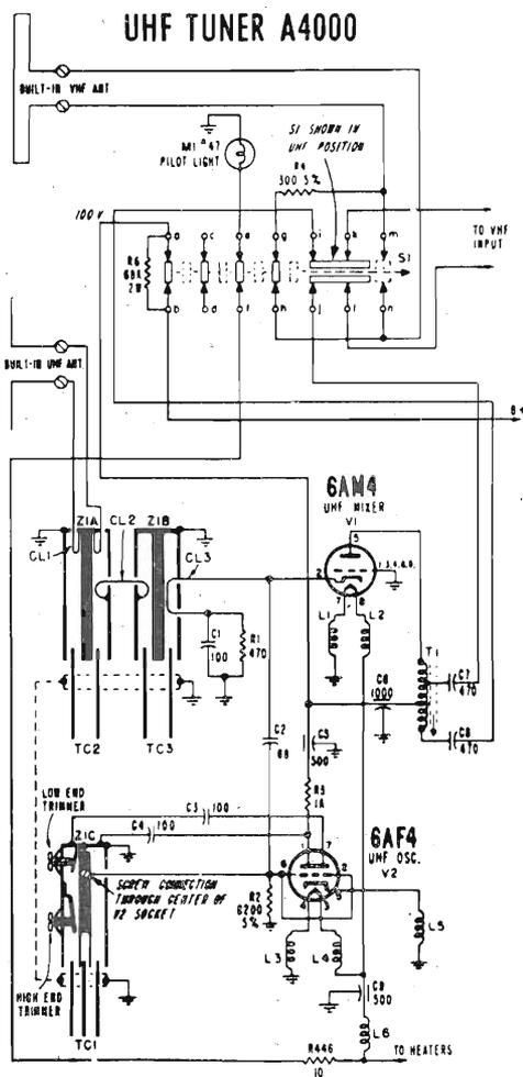
Fig. 14.42. - Schema complessivo del tuner UHF di produzione americana, di cui le quattro figure precedenti. È provvisto del commutatore (disegnato in alto) per il passaggio dalla ricezione VHF a quella UHF e viceversa.
