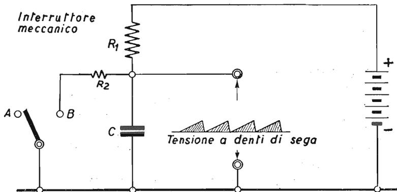
Fig. 8.1. - La tensione a denti di sega è ottenuta con la carica e scarica di un condensatore fisso.
