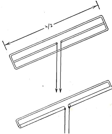
Fig. 17.23. - In alto, il dipolo a tre elementi; in basso, il dipolo disuguale.
