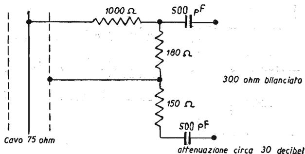
Fig. 17.53. - Caratteristiche delle scatole di derivazione, ad eccezione dell'ultima, degli impianti centralizzati. L'impedenza della linea principale è di 75 ohm, quella della linea derivata è di 75 ohm; la scatola provvede ad adattare le due impedenze ed a separare le linee.
