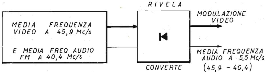
Fig. 7.24. - Il cristallo rivelatore provvede a rivelare il segnale MF-video, e a convertire di frequenza il segnale MF-audio.
