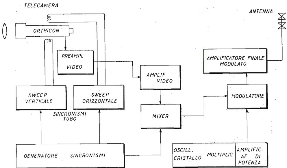
Fig. 18.14. - Schema a blocchi di stazione trasmittente televisiva.
