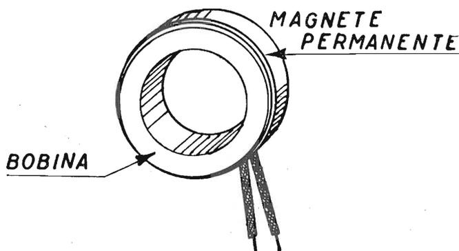
Fig. 4.9. - Bobina di messa a fuoco.
