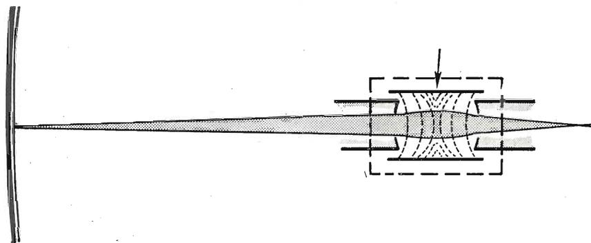
Fig. 4.12. - Principio della terza lente elettrica di cui sono provvisti i cinescopi moderni, a focalizzazione elettrostatica.
