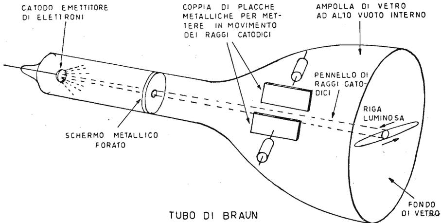
Fig. 1.4. - Il tubo di Braun. Esso costituì il punto d'inizio della televisione.
