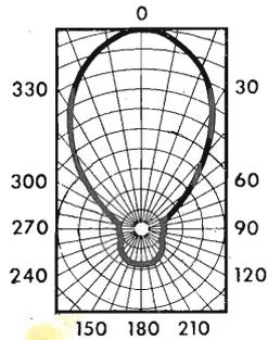
Fig. 17.28. - Diagramma polare della challengeer yagi di fig. 17.27.
