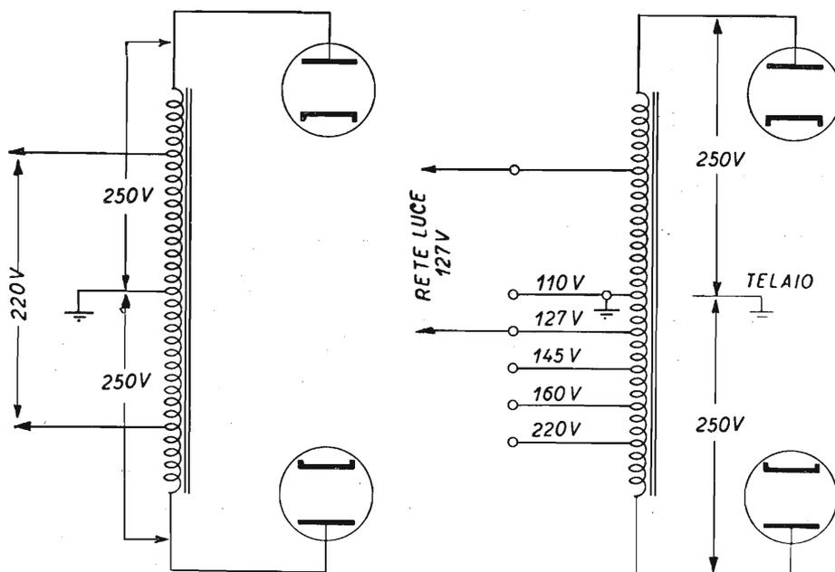
Fig. 12.6. - Autotrasformatore per la tensione della rete-luce.
