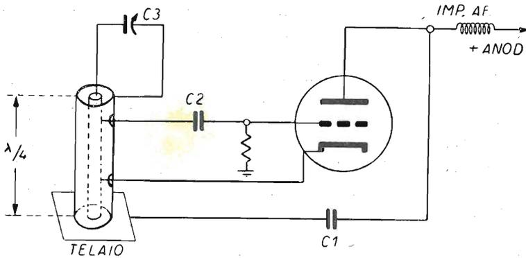
Fig. 14.21. - Principio del risonatore coassiale.
