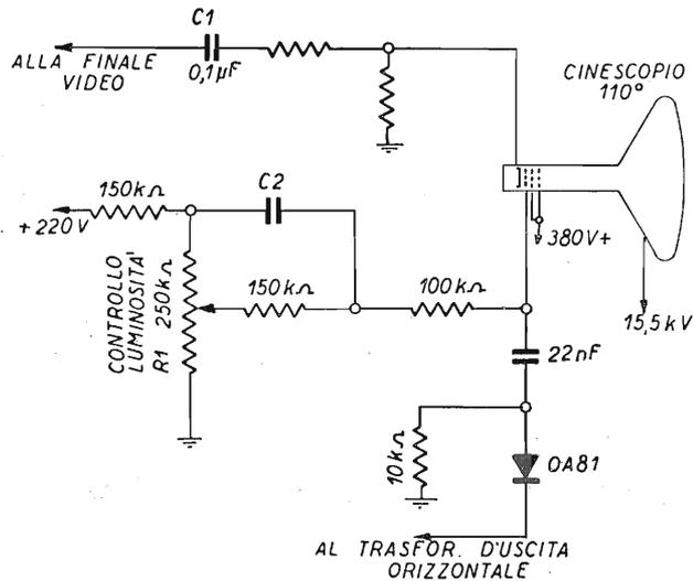
Fig. 7.42. - Esempio di controllo di luminosità presente nel circuito di griglia controllo di cinescopio.
