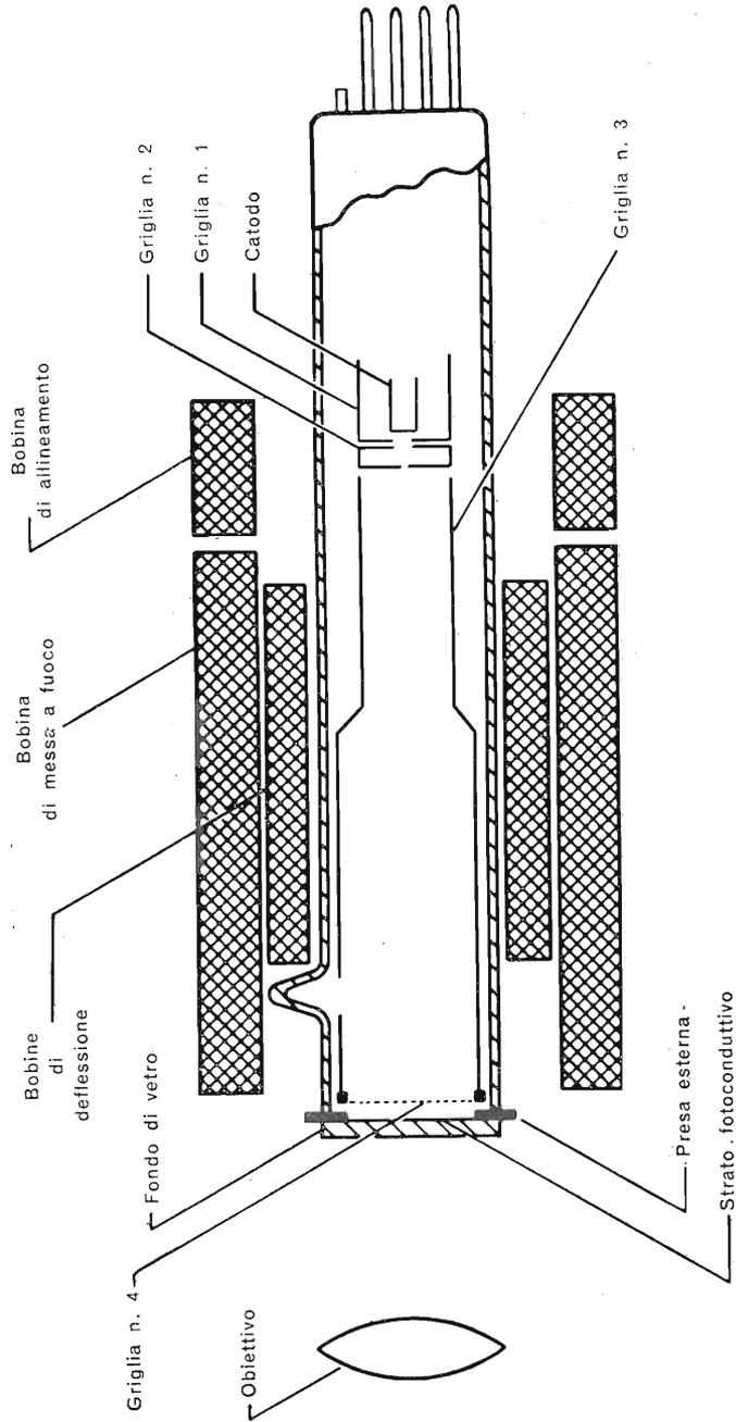
Fig. 18.10. - Principio del tubo da ripresa Vidicon.
