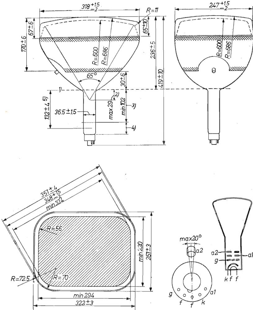
È a metallizzazione esterna. Per evitare la bruciatura ionica, è provvisto di una trappola ionica del tipo a proiettore elettronico inclinato. Il magnete della trappola ionica è il tipo 55402. Lo zoccolo del tubo è del tipo duodecale piccolo a 5 piedini.
