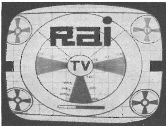
Fig. 6.14. - Come appare il monoscopio quando il controllo di linearità orizzontale non è ben regolato.
