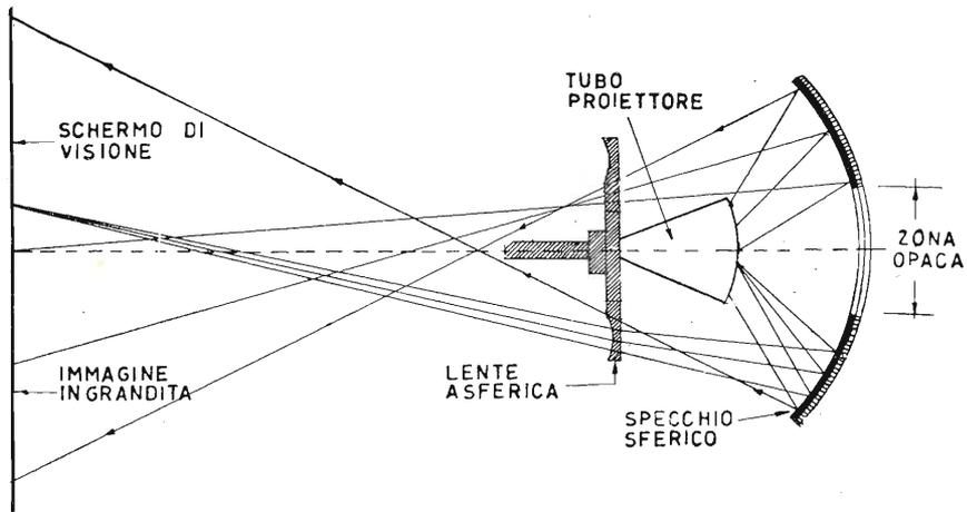
Fig. 15.2. - Tutti gli apparecchi riceventi di televisione provvisti di grande schermo a specchio, contengono un tubo elettronico proiettore di piccole dimensioni, e si basano sul sistema ottico Schmidt, utilizzato per i grandi telescopi, come quello di Monte Palomar.
