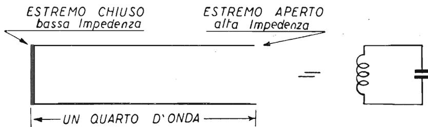
Fig. 14.17. - Linea risonante UHF e circuito accordato.
