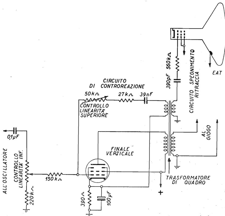
Fig. 9.4. - Circuito di deflessione verticale di tipo stabilizzato.
