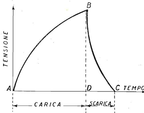
Fig. 8.2. - Curva di carica e scarica del condensatore.
