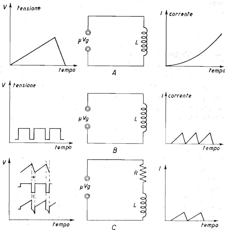
Fig. 8.17. - Affinchè nelle bobine di deflessione siano presenti onde di corrente a denti di sega è necessario che la tensione ad esse applicata abbia una particolare forma d'onda.
