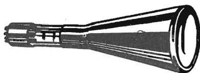
Fig. 2.4. - Tubo catodico a deflessione elettrostatica.
