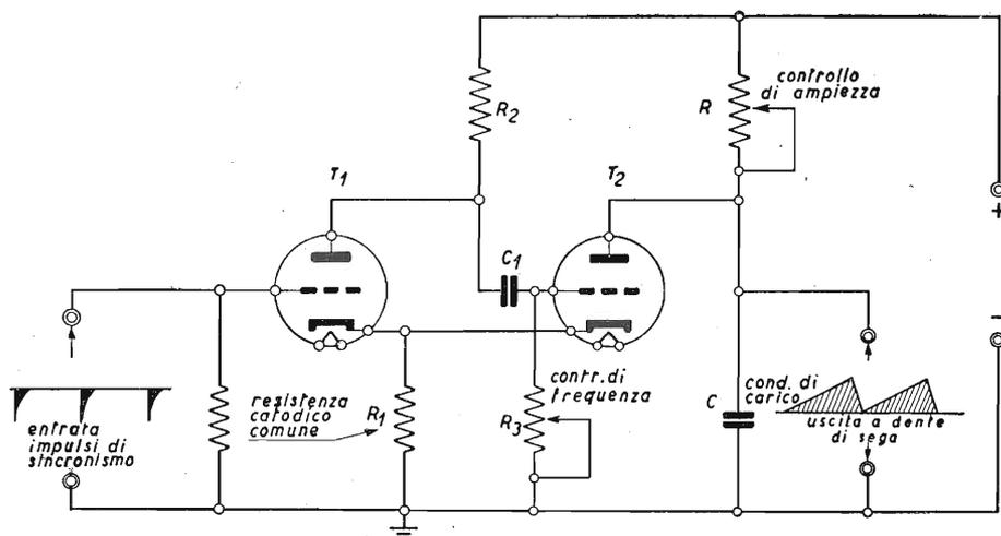
Fig. 8.12. - Principio di funzionamento dell'oscillatore a multivibratore.
