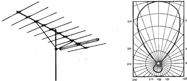
Fig. 17.25. - Dipolo a tre elementi di cui la fig. 17.24 e relativo diagramma polare.
