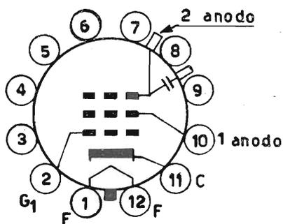
Tubo a visione diretta; deflessione e messa a fuoco elettromagnetiche. Trappola ionica con un solo magnete esterno. Bulbo di vetro con schermo rettangolare. Dimensioni dell'immagine: base cm 29 e altezza cm 21. Fluorescenza bianca. Angolo di deflessione: verticale 50°, orizzontale 65°. Zoccolo duodecicale a 5 piedini.
