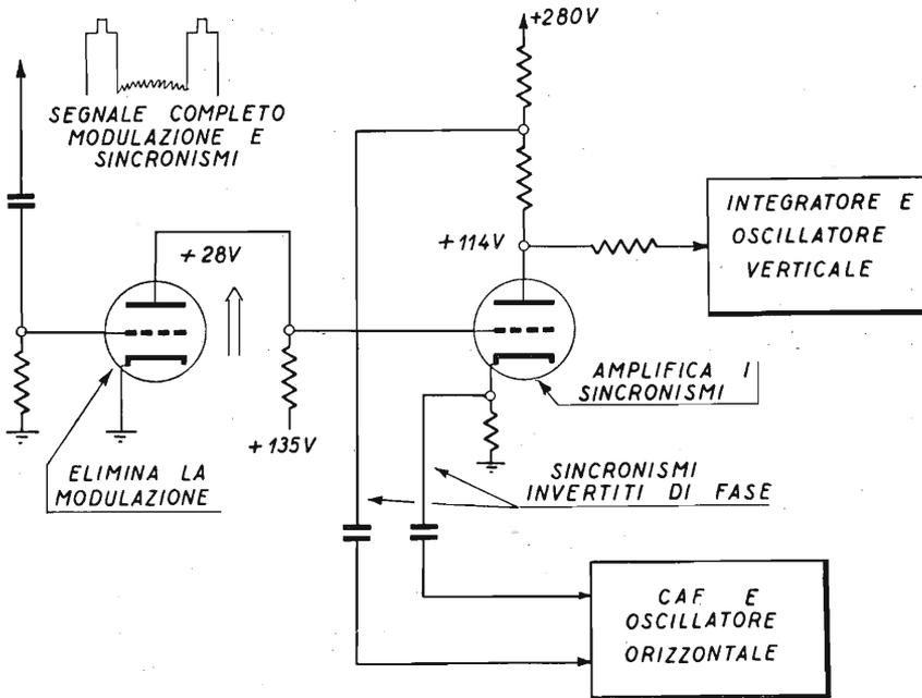
Fig. 11.3. - La valvola a sinistra, nello schema, elimina la modulazione, in quanto funziona con bassa tensione anodica; alla sua uscita vi sono i soli segnali di sincronismo, i quali vengono amplificati dall'altra valvola, quella a destra.
