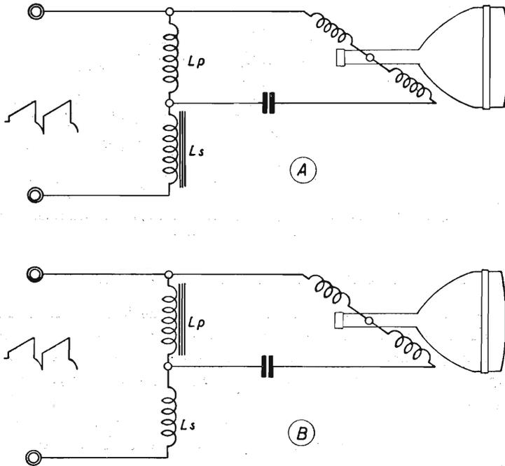
Fig. 10.15. - Controllo di ampiezza ad Impedenza costante della corrente a denti di sega.
