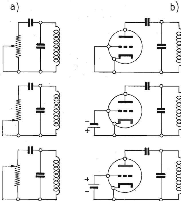
Fig. 13.27. - Principio di funzionamento della valvola a reattanza.
