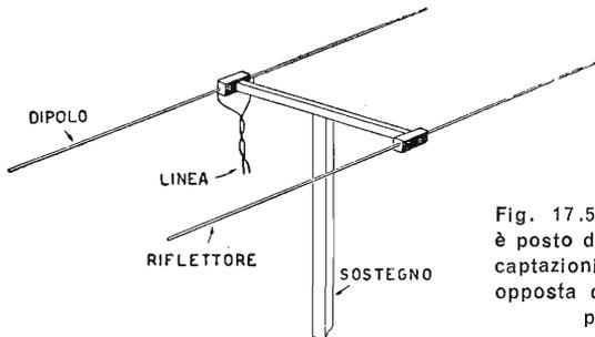
Fig. 17.5. - Dipolo con riflettore. Il riflettore è posto dietro il dipolo ed ha lo scopo di impedire captazioni di onde radio provenienti da direzione opposta da quella della trasmittente. Elimina soprattutto le onde riflesse da ostacoli.
