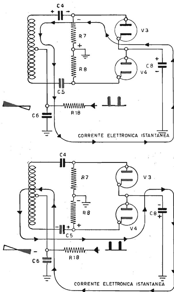
Fig. 13.19. - Circuito del discriminatore in cui si considera solo la tensione a denti di sega proveniente dall'uscita.
