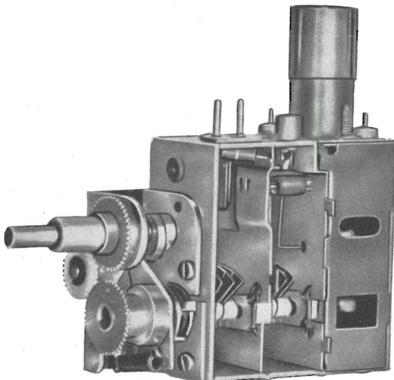
Fig. 14.44. - Aspetto esterno del tuner UHF Sickles-Ricagni, di tipo americano e di produzione nazionale.
