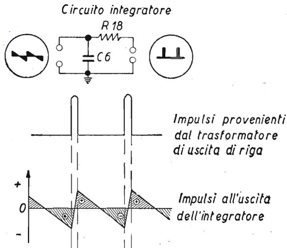
Fig. 13.18. - Integrazione degli impulsi di tensione.
