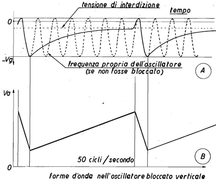
Fig. 8.8. - In alto frequenza naturale dell'oscillatore bloccato e frequenza degli Impulsi di corrente di placca; in basso corrispondente tensione a denti di sega ai capi del condensatore C. di fig. 5.6.
