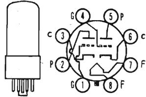
Tensione placca max . . . . . 500 V      Corrente catodo max . . . . . 60  $\mu$ A
