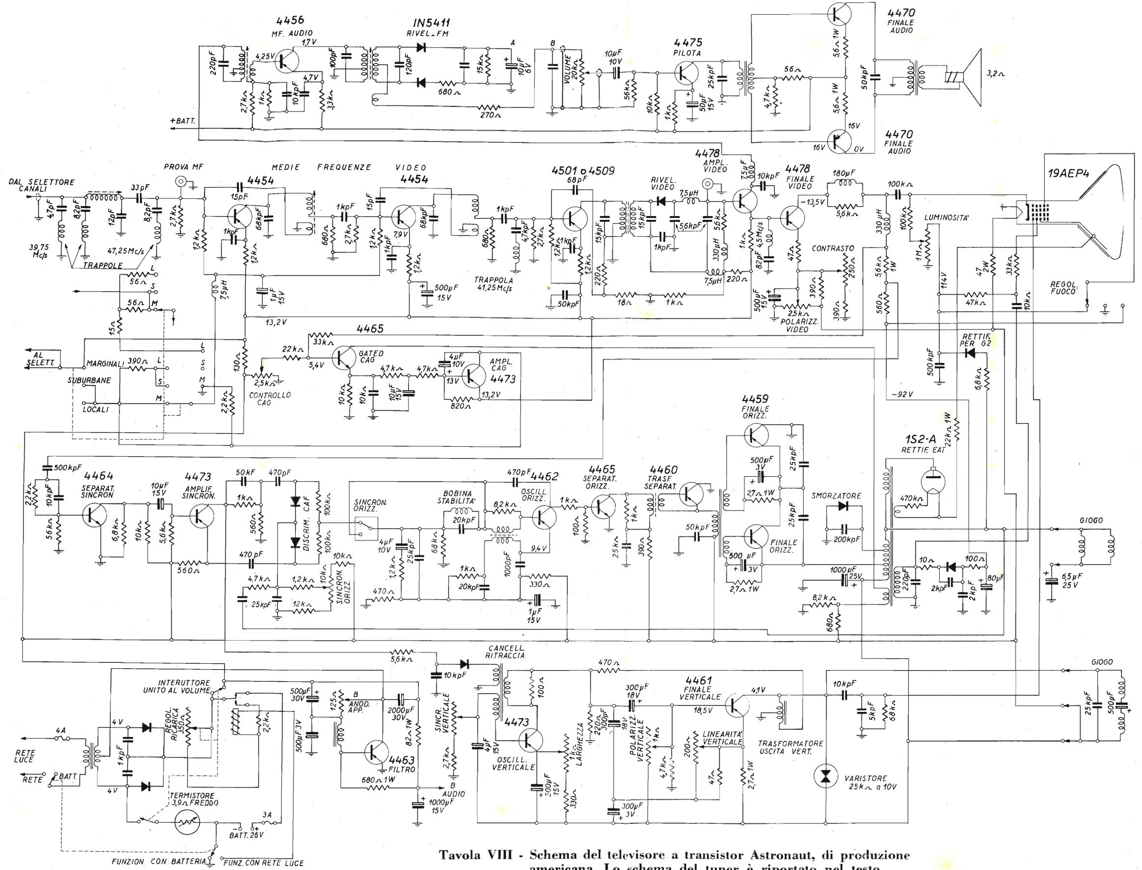
Tavola VIII - Schema del televisore a transistor Astronaut, di produzione americana. Lo schema del tuner è riportato nel testo.
