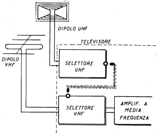
Fig. 14.2. - Televisore adattato per la ricezione UHF.
