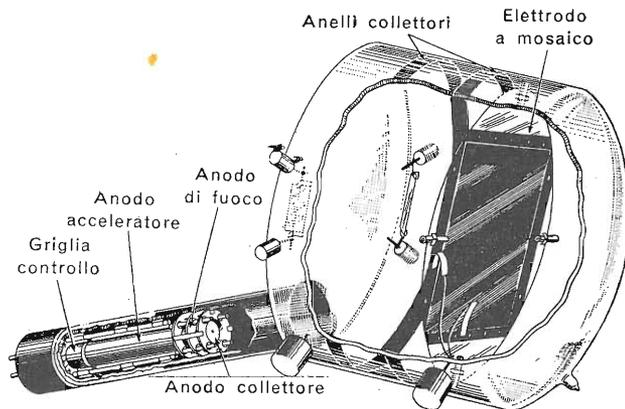
Fig. 18.9. - Iconoscopio RCA mod. 1850 A.
