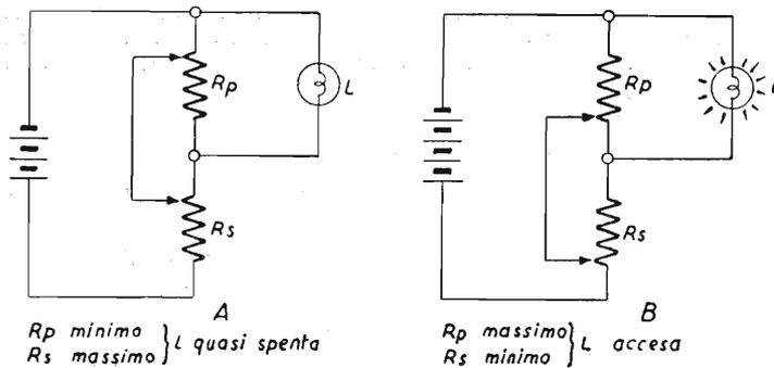
Fig. 10.14 - Principio di funzionamento del controllo di ampiezza a Impedenza costante.
