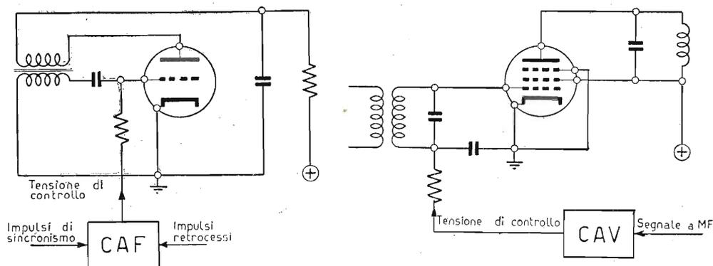
Fig. 13.7. - Similmente come il CAV controlla automaticamente l'amplificazione negli apparecchi radio, il CAF controlla automaticamente il sincronismo di riga nei televisori.
