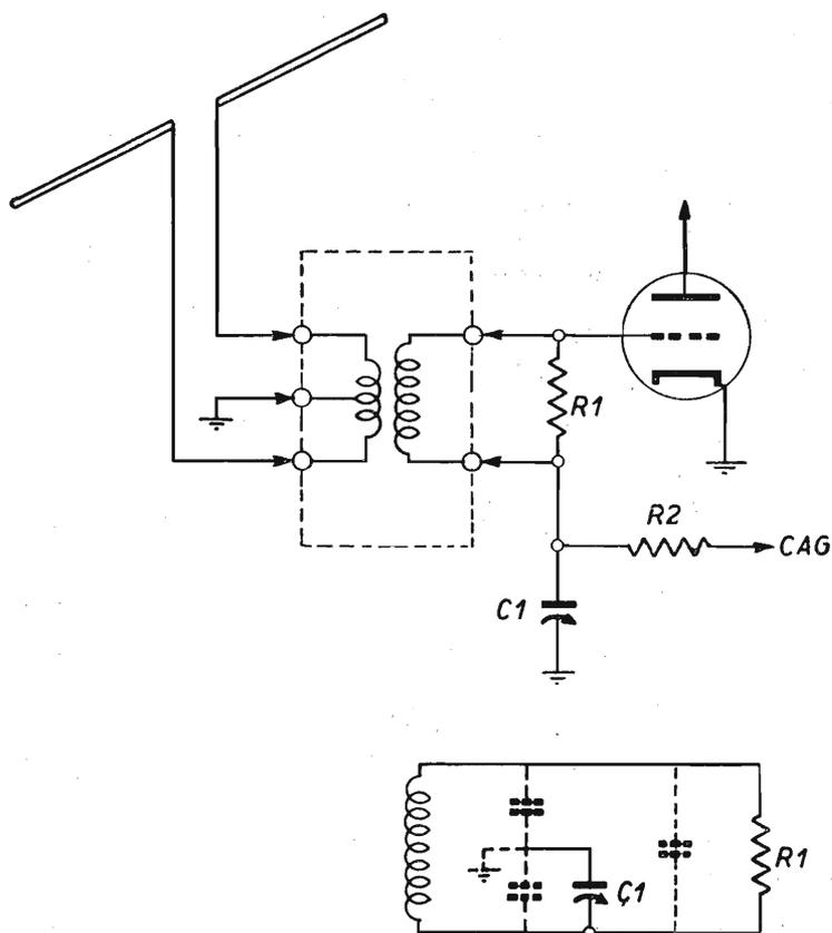
Fig. 7.6. - In alto, circuito d'entrata di televisore. Poichè funziona ad onde ultracorte, sono utilizzate le capacità interelettrodiche della valvola. L'allineamento è ottenuto con il compensatore C1. In basso, il circuito corrispondente.
