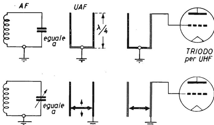
Fig. 14.16. - Collegamento del circuito risonante UHF alla valvola.
