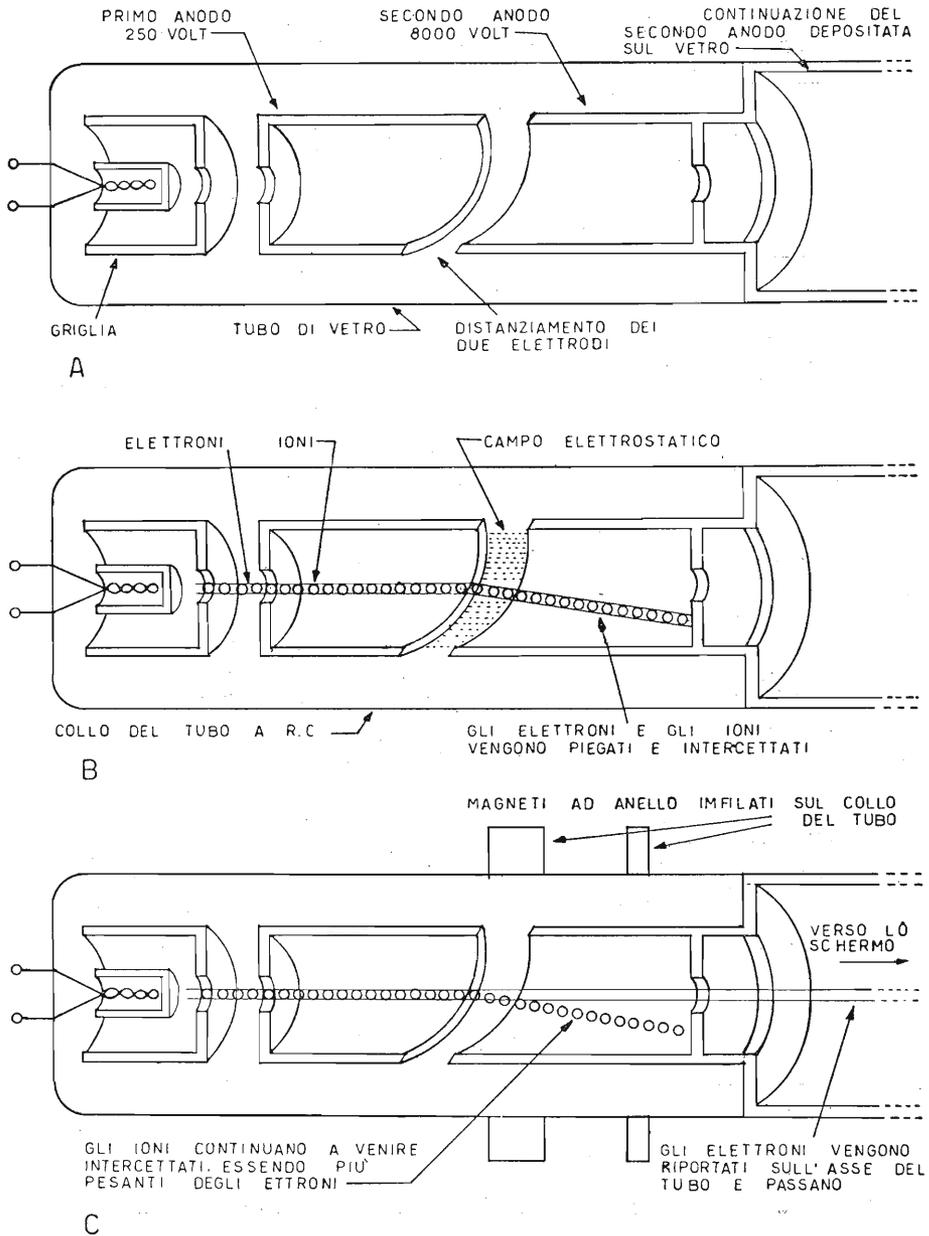
Fig. 4.16. - Principio di funzionamento della trappola ionica con proiettore diretto.
