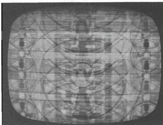
Fig. 6.18. - Esempio di assenza totale di sincronismo verticale.
