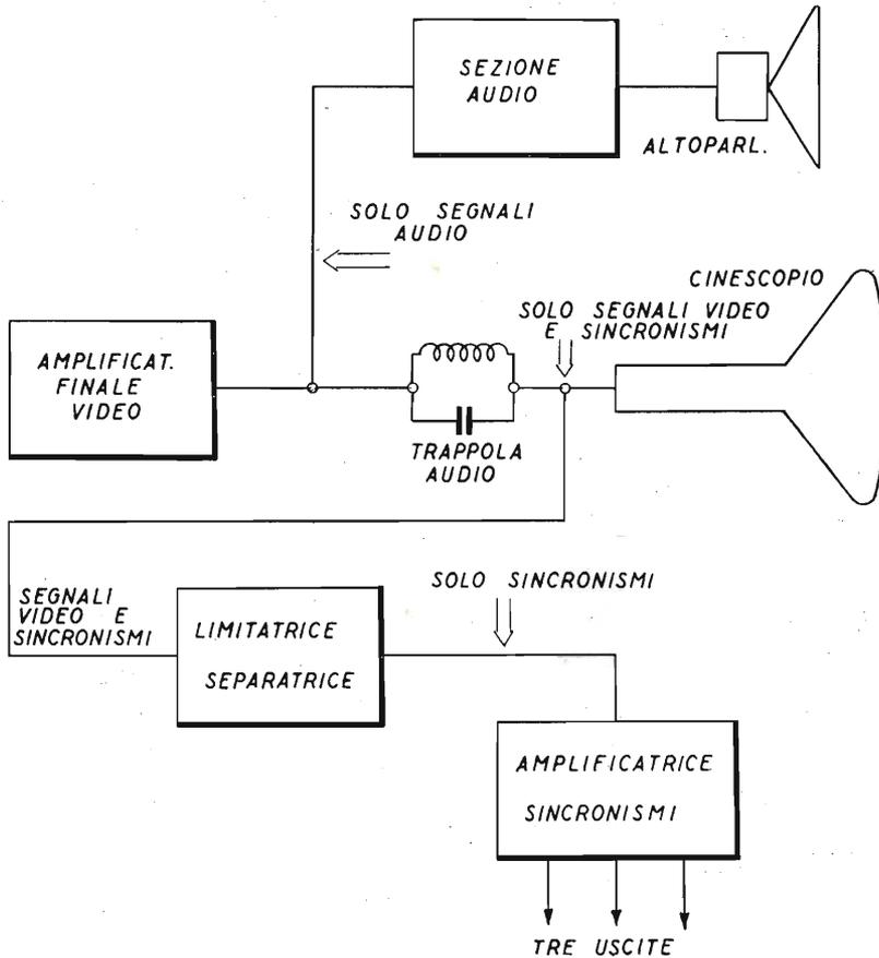
Fig. 11.2. - Schema a blocchi dei circuiti di sincronismo.
