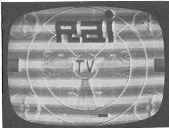
Fig. 6.10. - Barre nere sullo schermo per presenza di " suono nel video ", a causa di errata sintonia del televisore.
