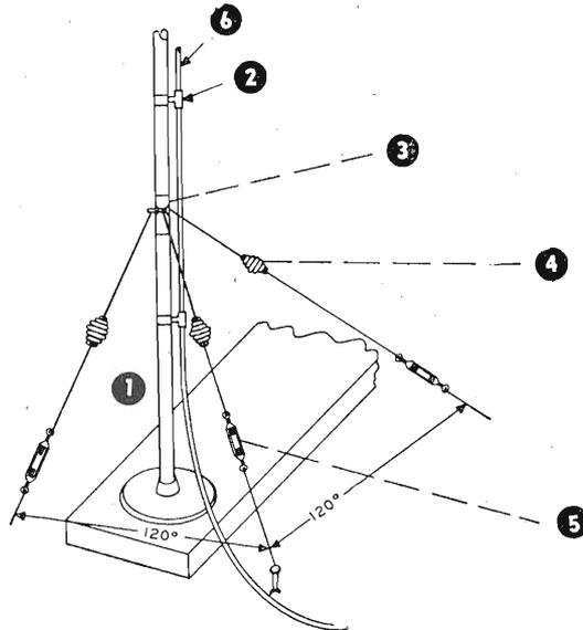
Fig. 17.45. - Esempio di sistemazione del palo di sostegno.
