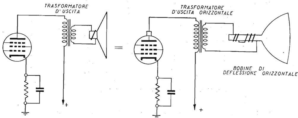
Fig. 10.1. - Le bobine di deflessione del cinescopio corrispondono alla bobina mobile dell'altoparlante, degli apparecchi radio.
