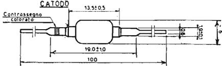
Diodo a germanio adatto per la reinserzione della componente continua al tubo catodico oppure come sopporitore della tensione per il controllo automatico di sensibilità.
