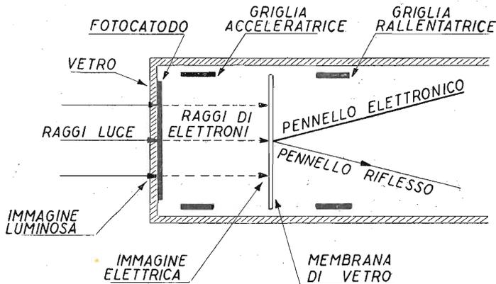
Fig. 18.3. - Principio del tubo da ripresa televisiva.
