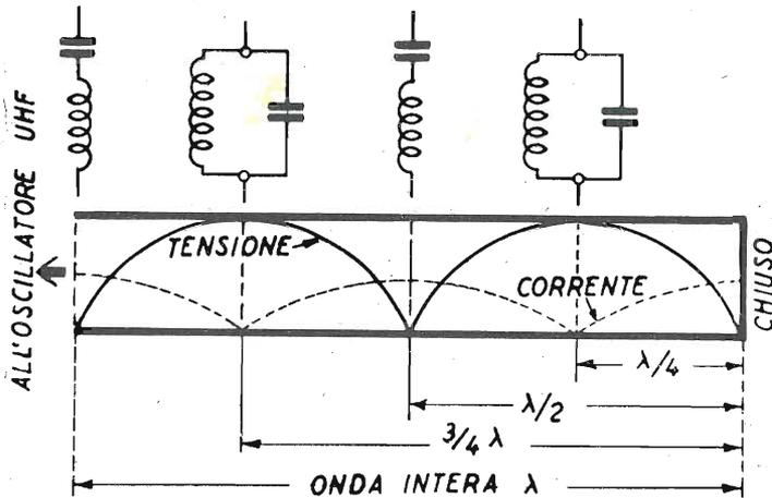
Fig. 14.14. - Esempio di circuito risonante UHF, chiuso.
