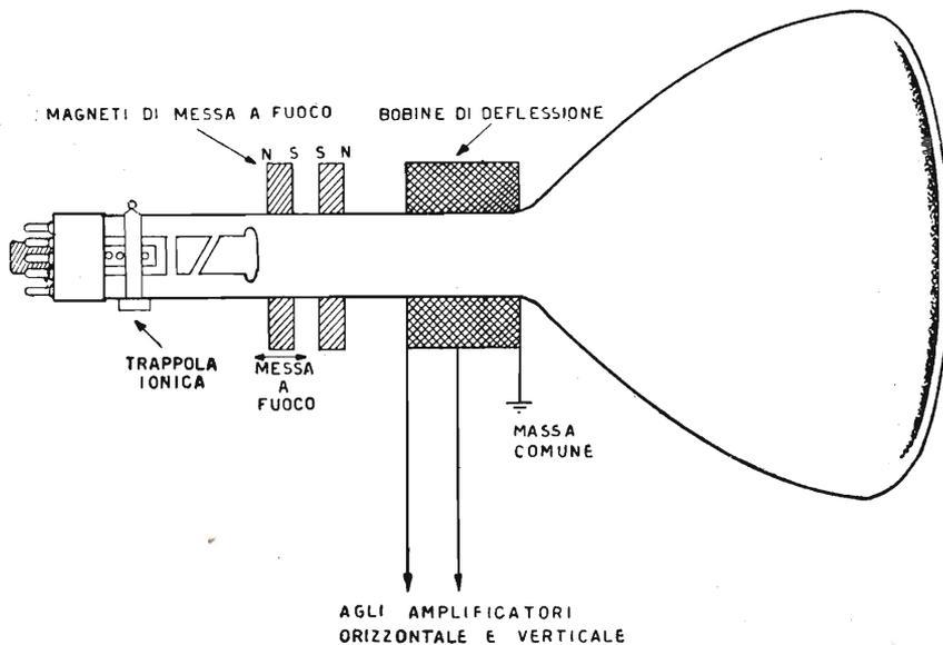
Fig. 4.11. - Sezione del tubo catodico di fig. 4.10.
