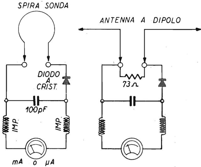
Fig. 14.20. - Schemi di ricevitori UHF con strumento indicatore.
