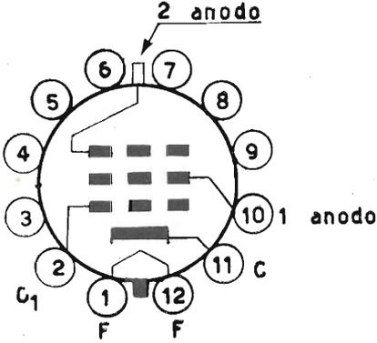
Tubo a visione diretta; deflessione e messa a fuoco elettromagnetica. Trappola ionica con un solo magnete esterno. Bulbo di vetro rettangolare con schermo di vetro grigio. Le dimensioni utili dell'immagine sono di 36 cm di base e 27 cm di altezza. Fluorescenza bianca. L'angolo di deflessione orizzontale è di 65° mentre quello di deflessione diagonale è di 70°. Lo zoccolo è duodecale a 5 piedini.
