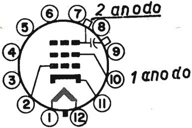
Tubo a visione diretta a deflessione elettromagnetica. Trappola ionica ad un magnete. È provvisto di metallizzazione interna. Le dimensioni utili dell'immagine sono di 49 cm di base e 35 cm di altezza. Fluorescenza bianca. Angoli di deflessione: orizzontale 65°, diagonale 70°. Lo zoccolo è duodecale a 6 piedini. Messa a fuoco magnetica.
