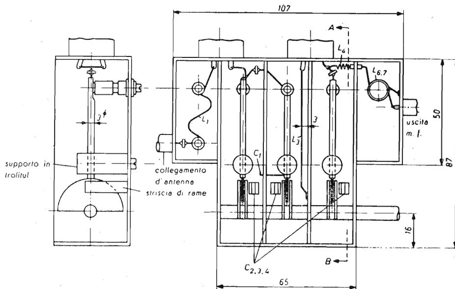
Fig. 14.35. - Aspetto del selettore UHF di tipo europeo.
