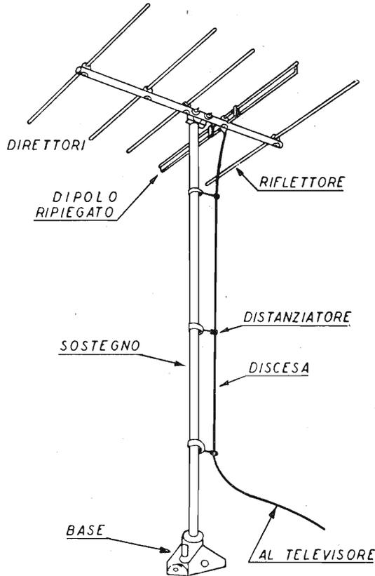
Fig. 17.21. - Antenna Yagi a 5 elementi.
