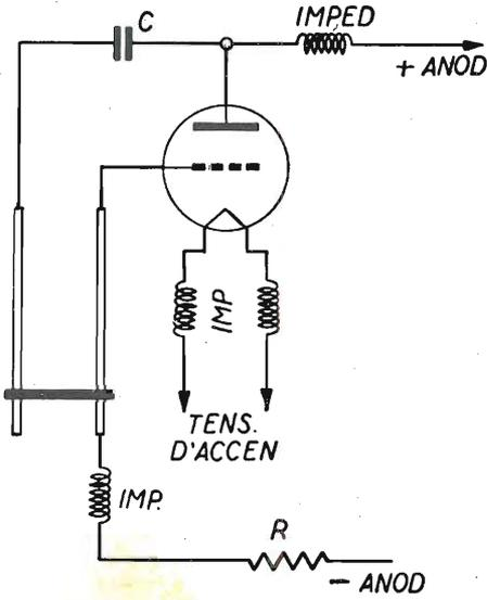
Fig. 14.19. - Schema di apparecchio oscillatore UHF.
