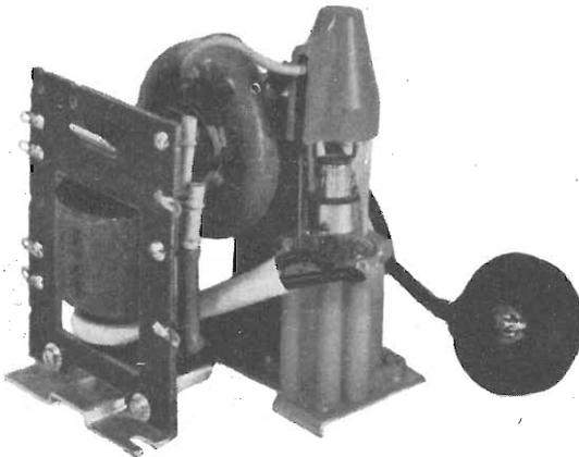
Fig. 10.24. - Esempio di trasformatore d'uscita di riga, con valvola rettificatrice ad extra alta tensione. Funziona con valvola finale orizzontale EL36 o PL36, con valvola EAT DY86 o DY87, e con diodo smorzatore EY81 o PY81. La tensione extra alta è di 15,5 chilovolt, quella rialzata è di 600 volt. La tensione di alimentazione anodica è di 200 volt.
