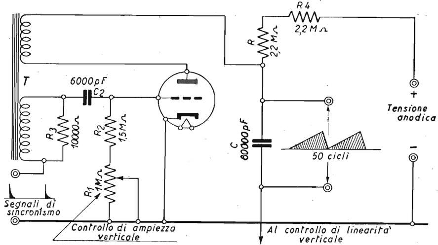
Fig. 8.9. - Schema di oscillatore bloccato verticale, funzionante alla frequenza di 50 c/s.
