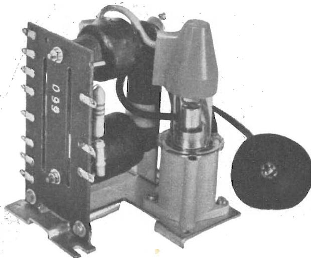
Fig. 10.25. - Esempio di trasformatore di riga e di generatore EAT. È simile a quello di fig. 10.24, ma è adatto per cinescopi a  $100^\circ$ , per cui è di potenza maggiore. L'avvolgimento extra alta tensione, non è di tipo a ciambella, come nell'esempio precedente. Funziona con le stesse valvole. Fornisce l'EAT di 15,5 chilovolt, ma con tensione rialzata doppia, di 1200 volt. La tensione di alimentazione anodica è sempre di 200 volt.
