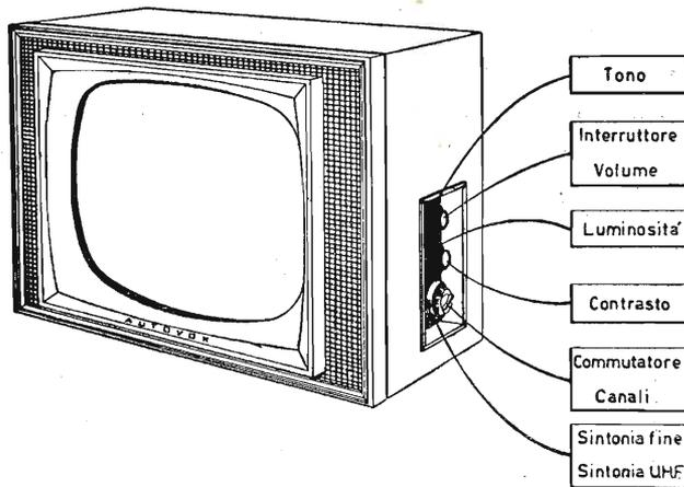
Fig. 6.22. - Esempio di comandi di televisore.
