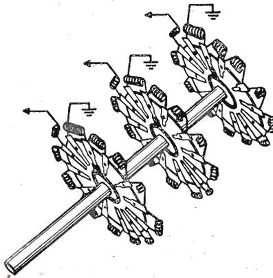
Fig. 7.14. - Esempio di selettore a commutatore per il passaggio da un canale TV all'altro.
