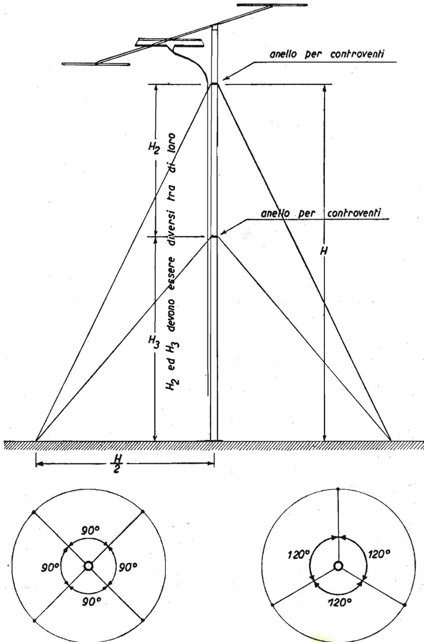
Fig. 17.46. - Posizione, lunghezza e fissaggio dei tiranti per la controventatura dell'asta di sostegno dell'antenna TV.
