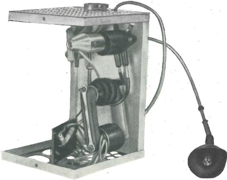
Fig. 10.26. - Il trasformatore di riga e il generatore EAT, con la propria valvola rettificatrice, sono contenuti entro un'apposita custodia metallica. La valvola è parzialmente visibile in alto, in parte nascosta dalla presa metallica al cappuccetto. A destra è visibile la presa a ventosa, da applicare al secondo anodo del cinescopio.
