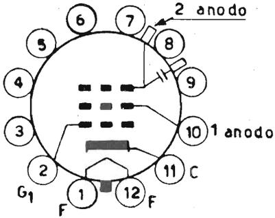
Tubo a visione diretta a deflessione elettromagnetica. Trappola ionica ad un magnete. È provvisto di metallizzazione interna. Le dimensioni utili dell'immagine sono 49 cm di base e 38 cm di altezza. Fluorescenza bianca. Angoli di deflessione: orizzontale 67°, diagonale 72°. Lo zoccolo è duodecal a 6 piedini. Messa a fuoco magnetica.
