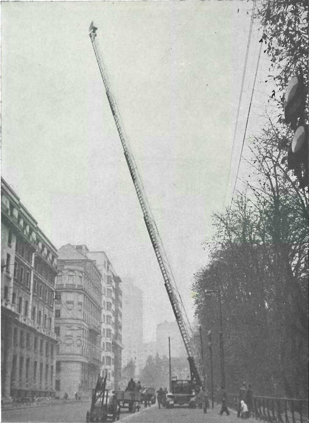
Fig. 18.19. - Antenna posta sull'estremità di alta scala, per ottenere il ponte radio con la trasmittente, durante una ripresa esterna, dallo Zoo di Milano.
