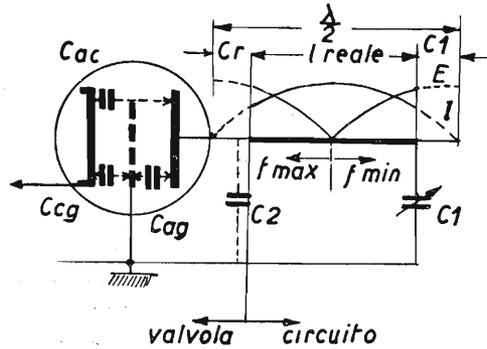
Fig. 14.31. - Conduttore centrale di risonatore UHF collegato alla valvola, con le capacità ai due estremi.
