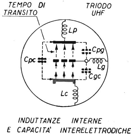
Fig. 14.4. - Induttanze dei collegamenti di uscita, e capacità tra gli elettrodi del triodo.
