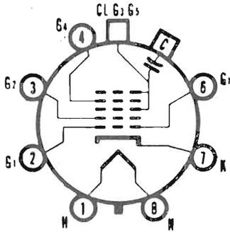
Tubo a visione diretta, con schermo rettangolare a superficie sferica, di vetro grigio alluminato. Deflessione magnetica e focalizzazione elettrostatica. Cannone diritto con lente tripotenziale. Senza trappola ionica. Lunghezza totale del tubo 378 mm, lunghezza del collo 130 mm. Fluorescenza bianca. Trasparenza 76.
