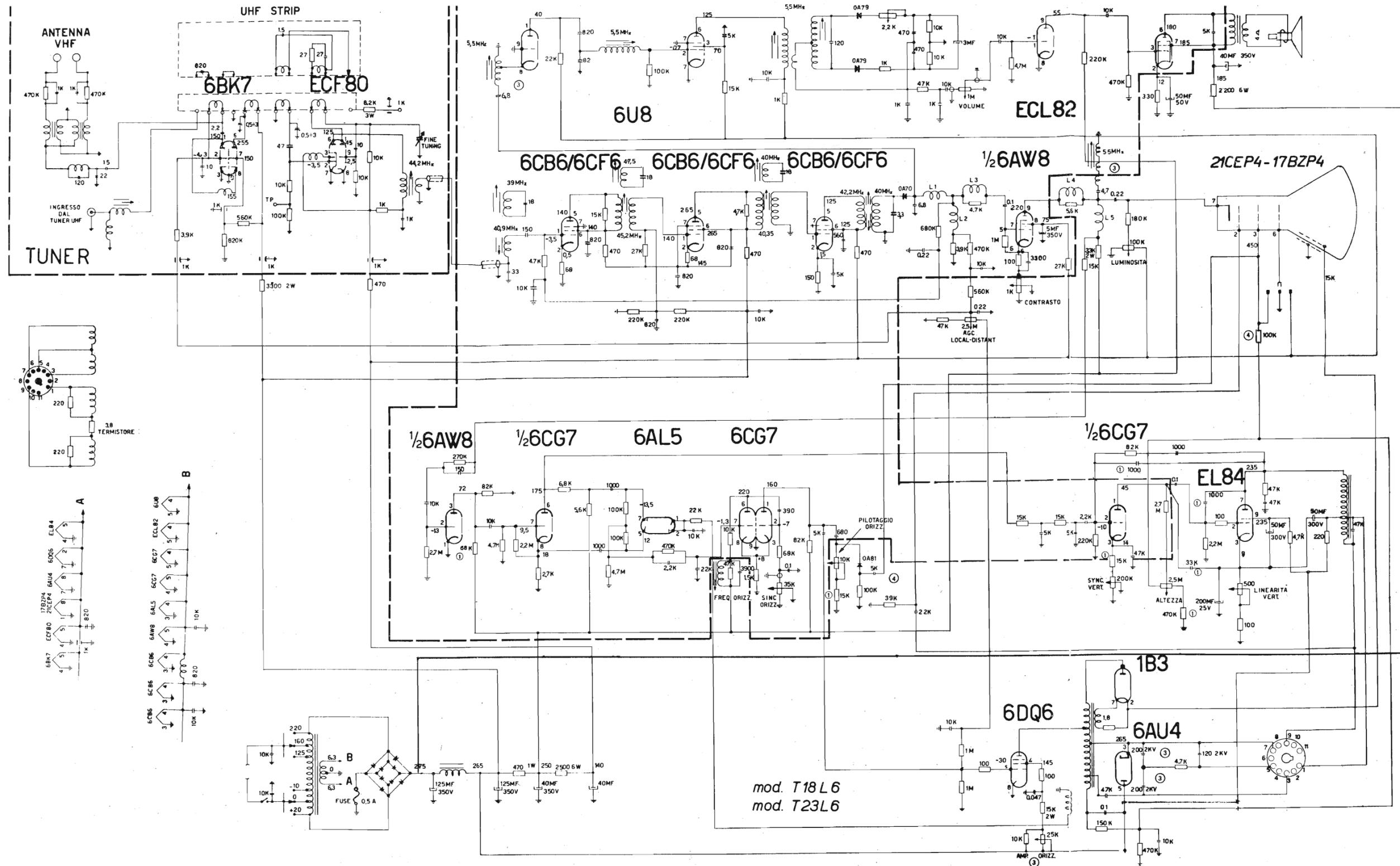
ADMIRAL — Televisori modelli T 18L6 e T 23L6. Lo schema corrisponde anche ai modelli T 18M26 e T 23M26, i quali sono però provvisti di due altoparlanti e di controllo di tono, con una resistenza variabile di 0,5 megaohm, in serie con condensatore fisso di 5 000 pF, nel circuito di placca della valvola finale audio. La disposizione delle varie sezioni e dei vari circuiti è quella indicata per i modd. T 18D36 e T 23D36.
