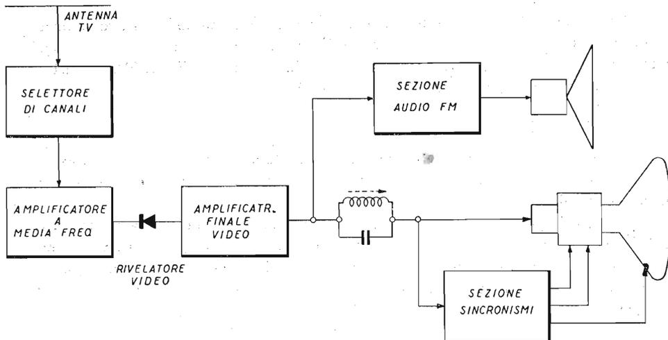
Fig. 7.4. - Schema a blocchi di televisore.
