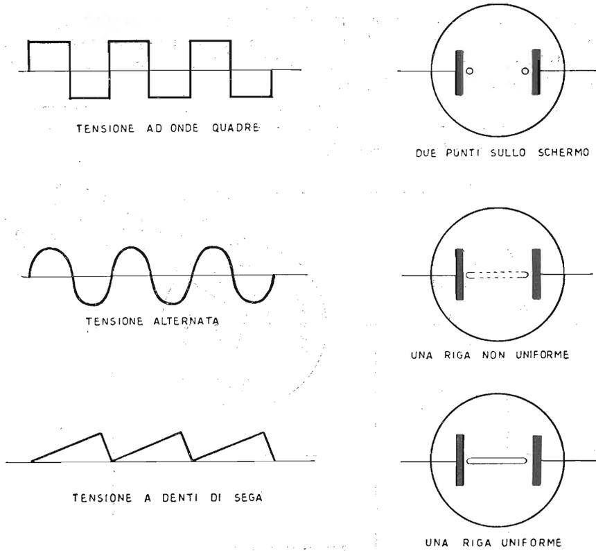
Fig. 3.10. - Solo la tensione a denti di sega può comandare il pennello elettronico, in modo da fargli tracciare una riga uniformemente luminosa.
