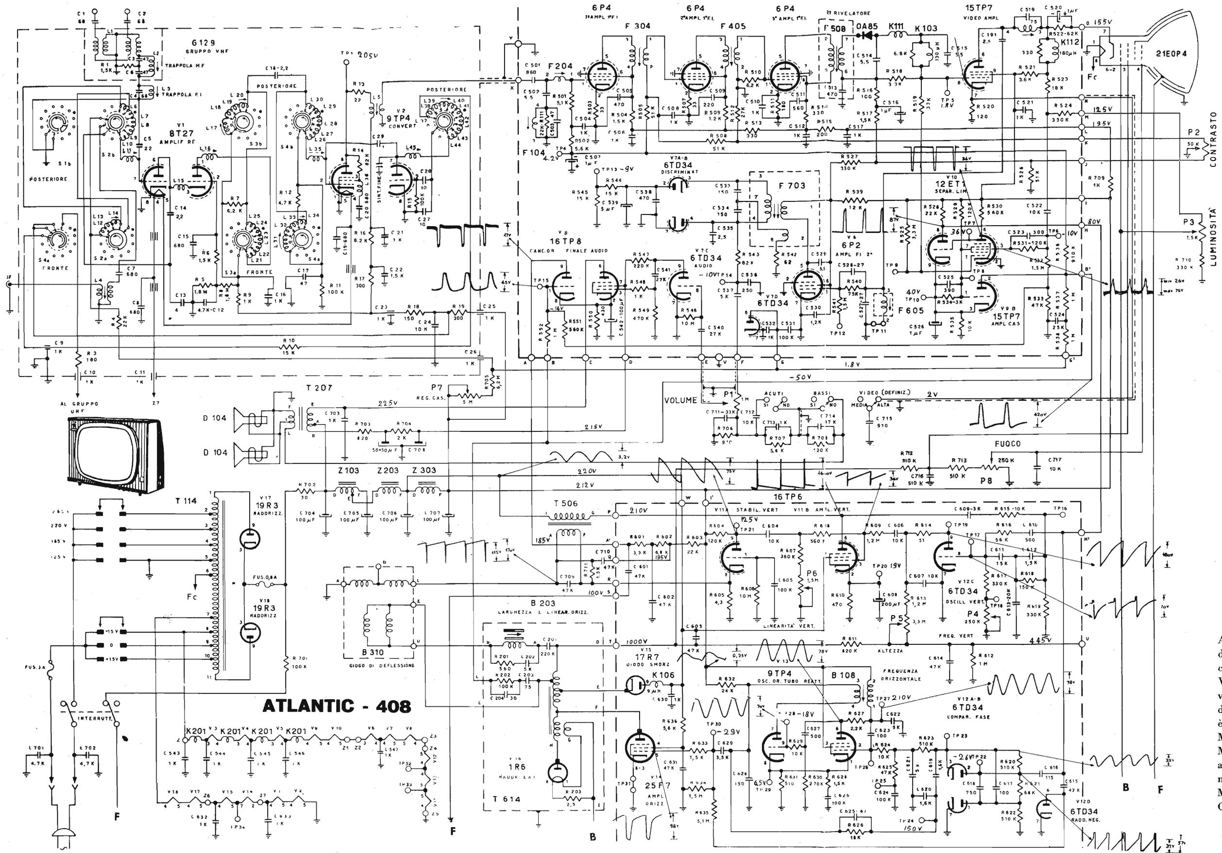
ATLANTIC — Televisore modello 408. Apparecchio a circuiti stampati, con selettore VHF, predisposto per il convertitore UHF. La disposizione delle varie parti dello schema è quella stessa del mod. 404. Media frequenza video a 45,75 Mc/s, prima media frequenza audio a 40,25 Mc/s, seconda media frequenza audio a 5,5 Mc/s. Resa d'uscita 2 watt. Consumo 180 watt.
