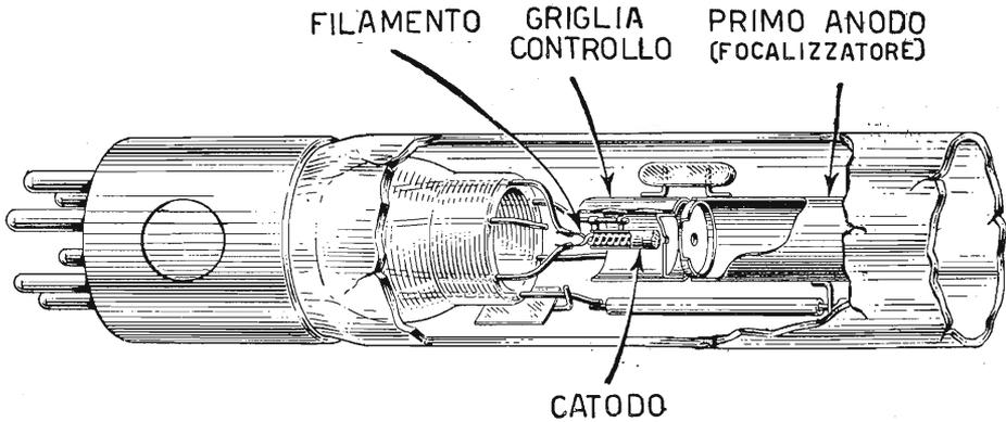
Fig. 2.2. - Struttura della prima parte del proiettore elettronico.
