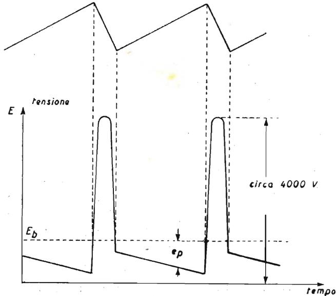
Fig. 10.4. - Andamento degli impulsi di tensione retrocessi nel circuito di placca della valvola finale in corrispondenza di ciascun tratto discendente della tensione a denti di sega.
