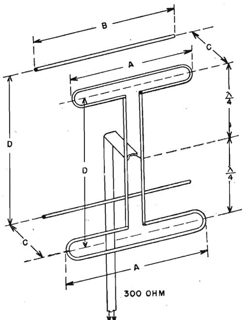
Fig. 17.31. - Caratteristiche di doppio dipolo con riflettore.
