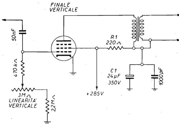
Fig. 9.3. - Uscita verticale e controllo di linearità.
