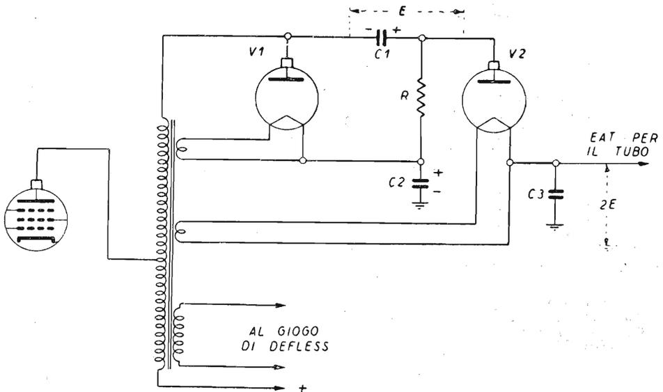
Fig. 10.28. - Schema di generatore EAT a raddoppiamento di tensione.
