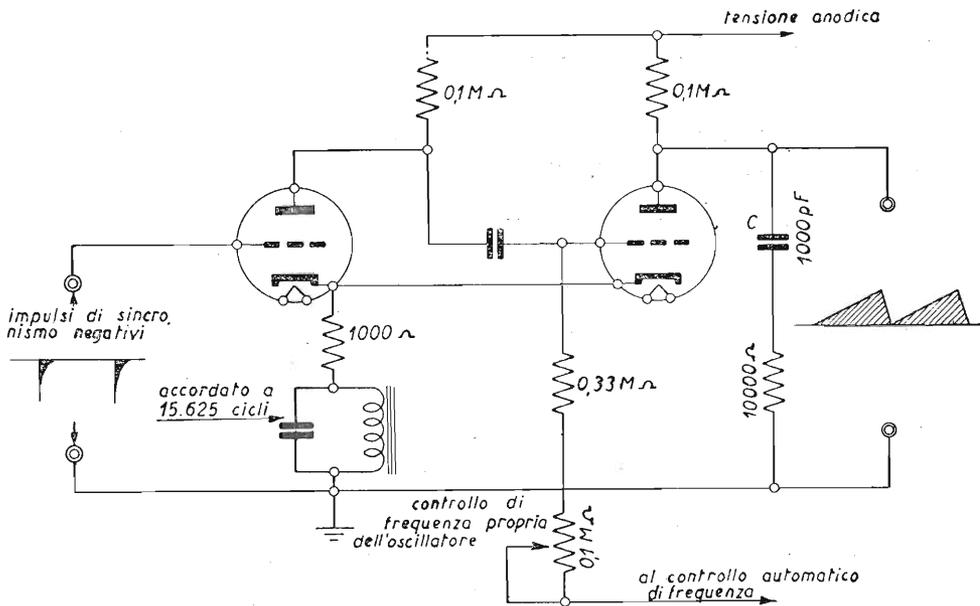
Fig. 8.16. - Esempio pratico di oscillatore orizzontale a multivibratore.
