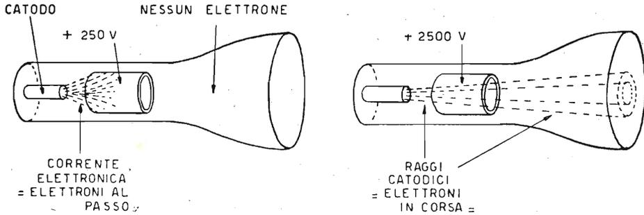
Fig. 2.1. - A sinistra, data la bassa tensione applicata all'anodo cilindrico, gli elettroni emessi dal catodo vengono da esso assorbiti. È presente nel tubo la corrente elettronica. A destra, data l'alta tensione applicata all'anodo cilindrico, nel tubo vi sono raggi catodici che attraversano l'anodo e raggiungono lo schermo.
