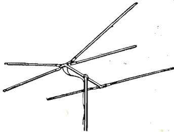
Fig. 17.34. - Dipolo a V con riflettore.
