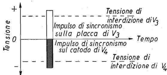
Fig. 13.20. - Impulsi e tensione di Interdizione dei diodi.
