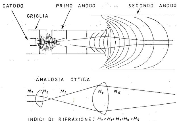
Fig. 2.6. - Principio della lente elettrica convergente e analogia con la lente ottica.
