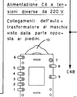
Le misure sono eseguite senza segnale d'antenna, Contrasto al max., Luminosità al minimo e voltmetro di resistenza interna di almeno 20.000 ohm per Volt (le tensioni sono indicate verso massa).
