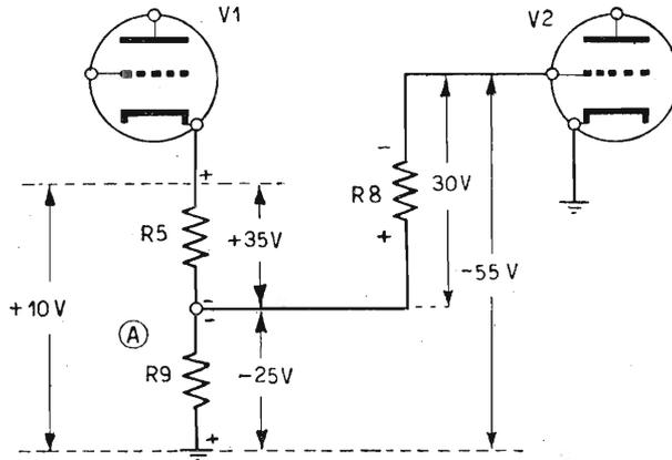
Fig. 13.12. - Distribuzione delle tensioni tra l'oscillatore e la valvola di controllo del CAF.
