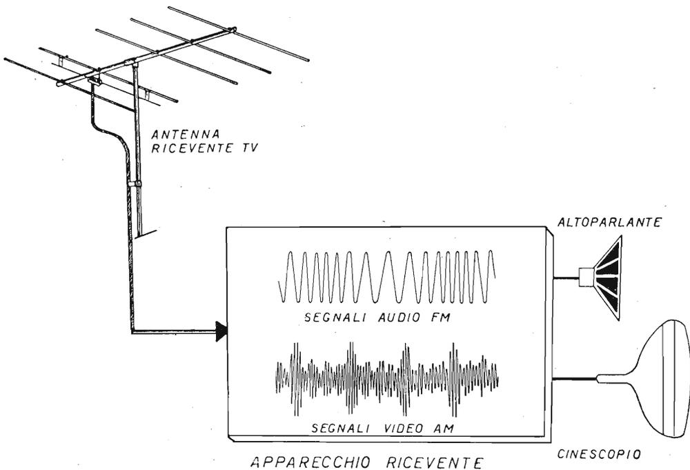
Fig. 7.2. - Nel televisore sono presenti due segnali, uno a modulazione di ampiezza (video) e l'altro a modulazione di frequenza (audio).
