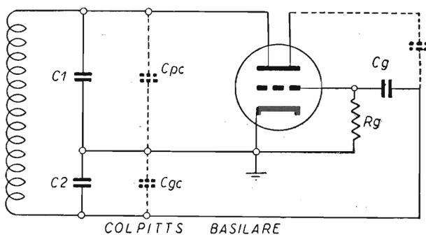
Fig. 14.10. - Esempio di oscillatore UHF a triodo.
