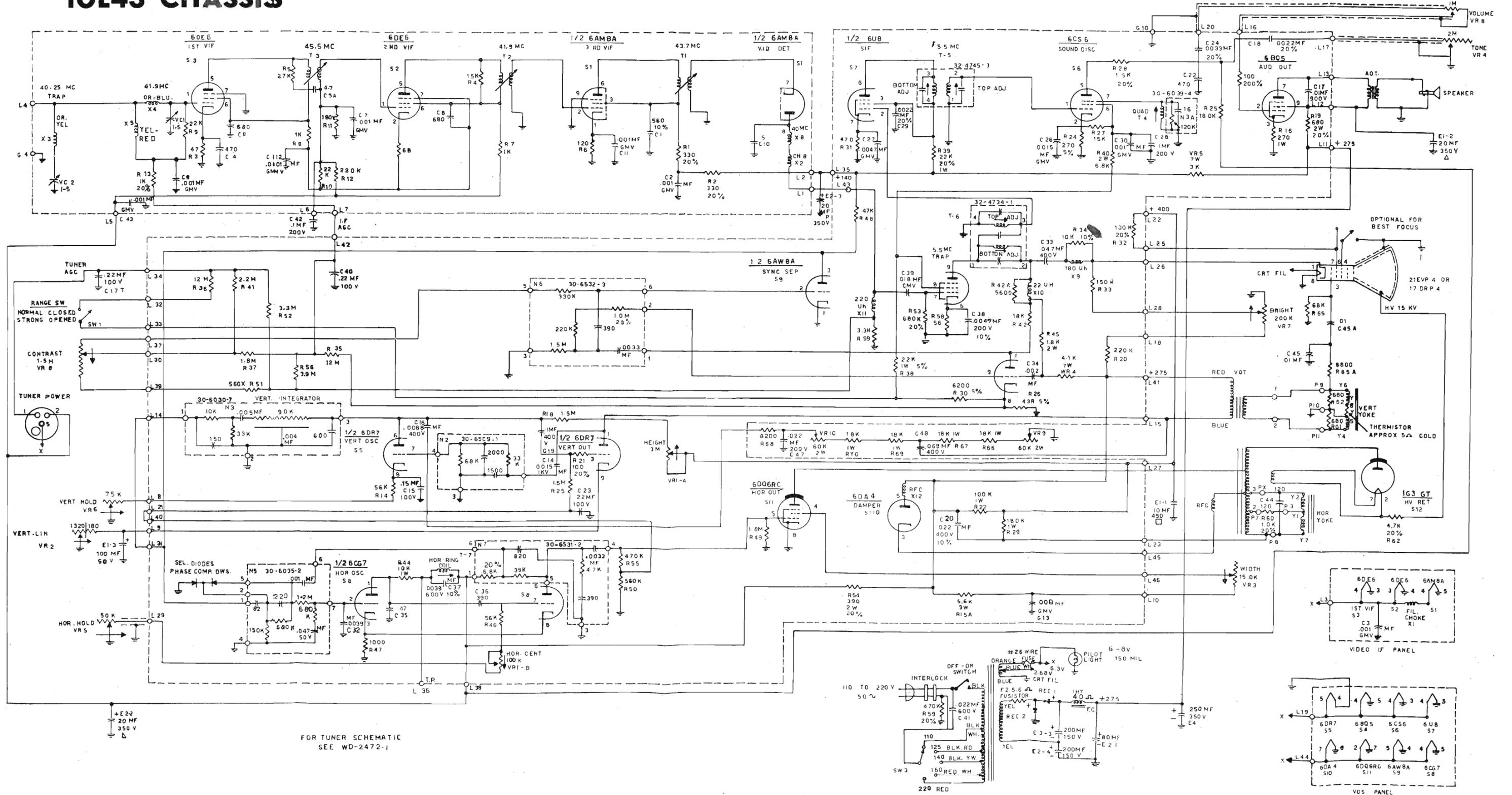
PHILCO ITALIANA — Televisori con chassis mod. 10L43, a circuiti stampati. A sinistra è riportato lo schema del tuner VHF. I pannelli a circuiti stampati sono due, uno per l'amplificatore a media frequenza video, comprendente il diodo rivelatore; e l'altro per tutte le altre valvole, esclusa soltanto la rettificatrice EAT. L'alimentatore anodico è provvisto di trasformatore di tensione, con due rettificatori al selenio.
