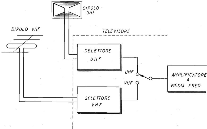
Fig. 14.1. - Televisore con cambio di selettori.
