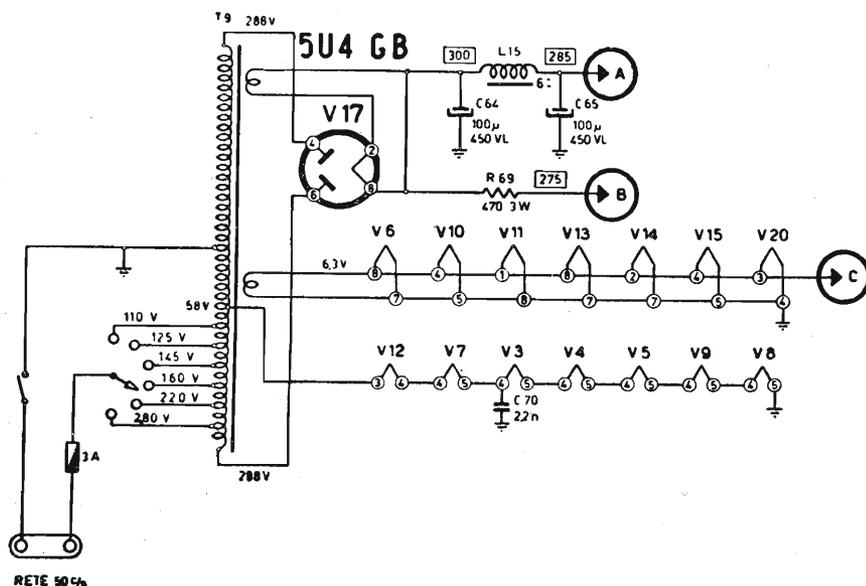
Fig. 12.14. - Alimentatore di tensione anodica di una serie di televisori Voxson-Faret.
