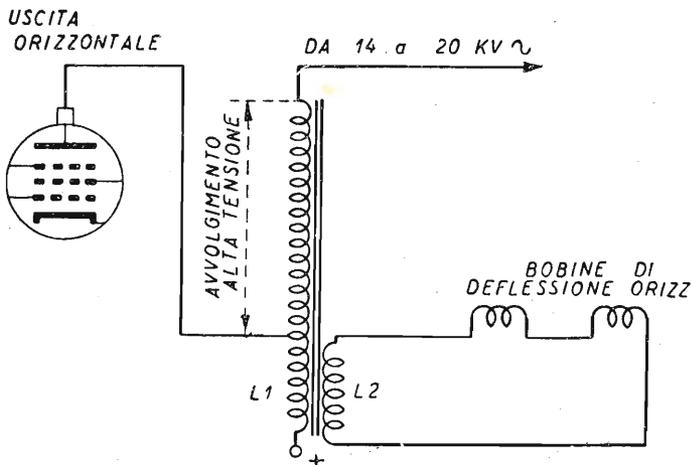
Fig. 10.3. - L'avvolgimento ad extra alta tensione.
