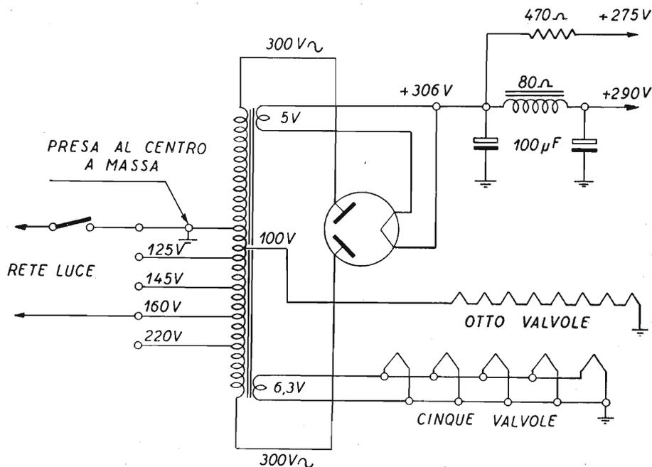
Fig. 12.7. - Esempio di alimentatore con autotrasformatore, con il centro dell'avvolgimento collegato a massa.
