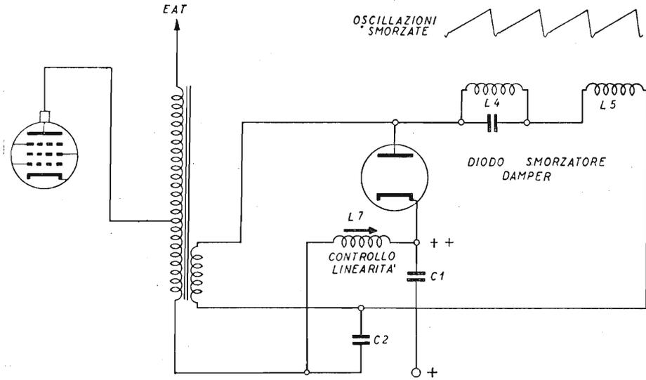
Fig. 10.12 A. - Il diodo smorzatore (detto anche BOOSTER o DAMPER) provvede ad eliminare le oscillazioni nocive all'inizio dei denti di sega, di cui la figura precedente. In questo esempio è usato un trasformatore d'uscita orizzontale.
