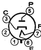
Tensione d'accensione 6,3 V; corrente d'accensione 1,2 A. Massima ampiezza della tensione inversa: come raddrizzatore 1250 V; come smorzatore 3850 V; massima ampiezza della corrente anodica a regime 600 mA; massimo picco transitorio (0,2 sec. max) della corrente anodica 3,5 A.
