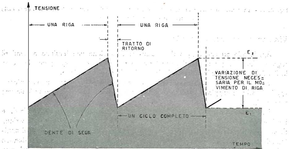
Fig. 3.11. - Caratteristiche della tensione a denti di sega.
