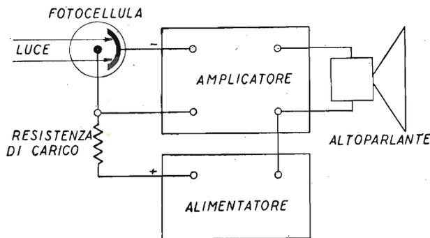
Fig. 18.2. - Principio di applicazione della cella fotoelettrica.
