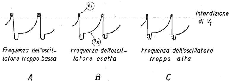
Fig. 13.10. - Forme d'onda risultanti del circuito CAF.
