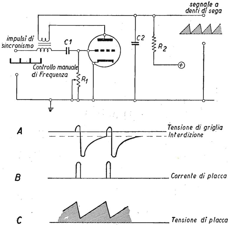
Fig. 13.5. - Principio di funzionamento di un oscillatore bloccato.
