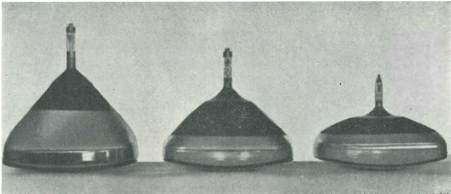
Fig. 4.21. - Aspetto esterno di tre cinescopi, con angolo di deflessione di 70° (a sinistra) di 90° (al centro) di 110° (a destra).
