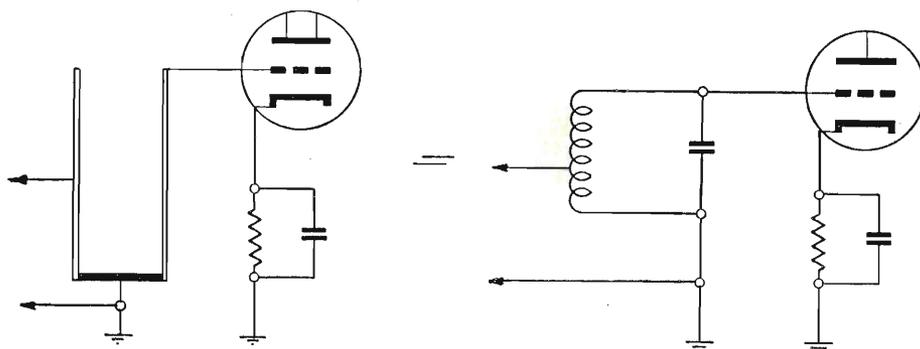
Fig. 14.18. - Linea risonante UHF con presa.
