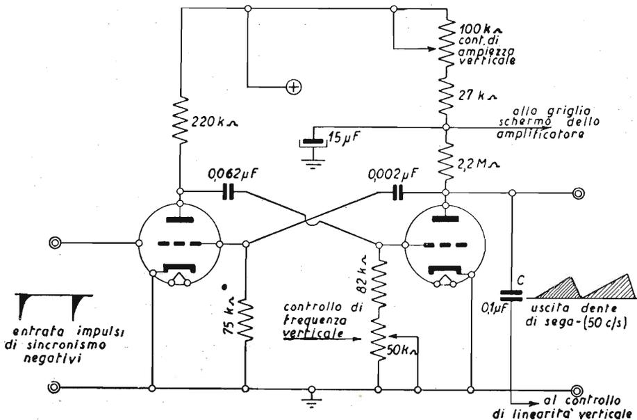
Fig. 8.15. - Esempio pratico di oscillatore verticale a multivibratore.
