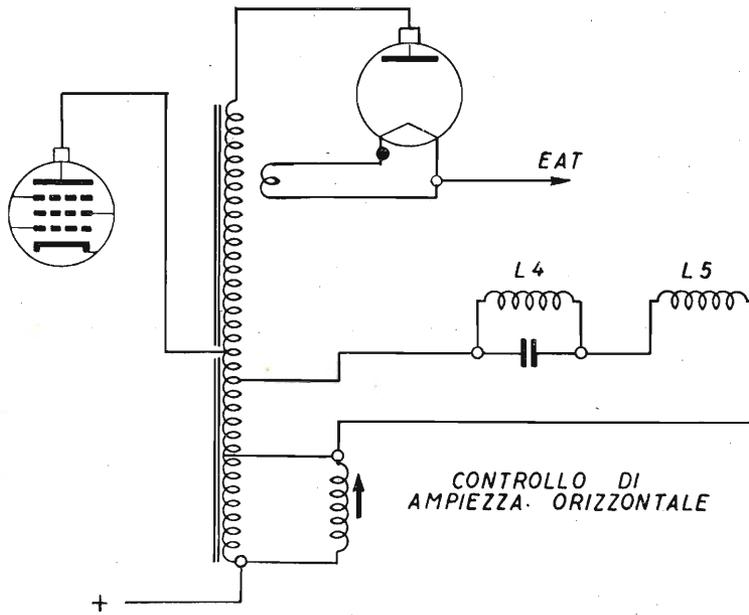
Fig. 10.17. - Principio del controllo di larghezza con autotrasformatore.
