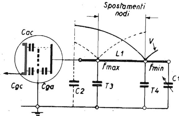
Fig. 14.32. - Punti di allineamento alto e basso, di risonatore UHF.
