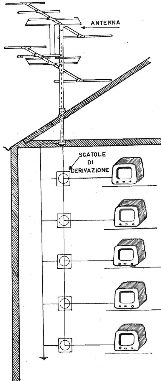
Fig. 17.49. - Esempio di impianto televisivo centralizzato, senza amplificatore di antenna.
