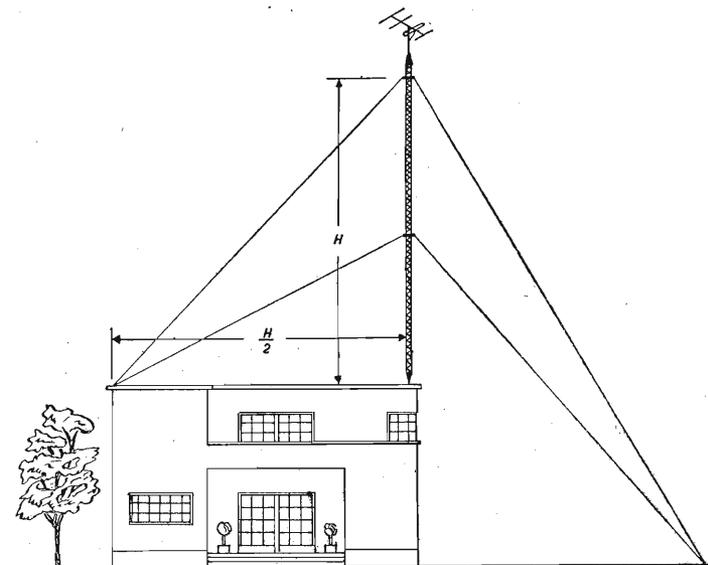
Fig. 17.47. - Sostegno a traliccio per antenne in zone marginali, a basso segnale TV. Il sostegno è a traliccio, provvisto di tiranti di controventatura.
