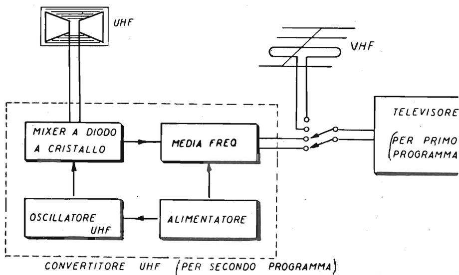
Fig. 14.3. - Televisore con tuner UHF di tipo americano.
