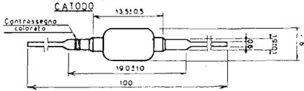
Diodo rettificatore a germanio adatto per la rivelazione del segnale video all'uscita dell'amplificatore MF-video dei televisori.
