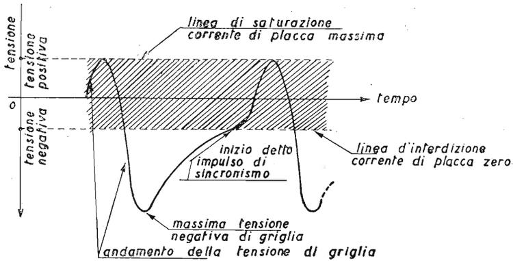
Fig. 8.7. - Andamento della tensione di griglia della valvola oscillatrice bloccata.
