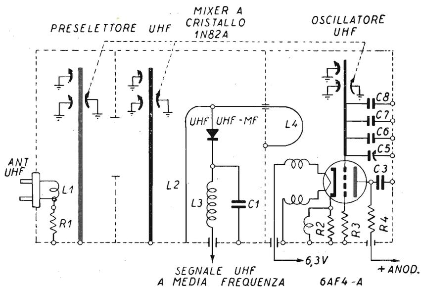
Fig. 14.33. - Schema di tipico tuner UHF, di tipo americano, presente in molti televisori di produzione nazionale.
