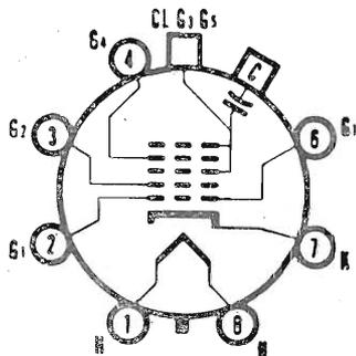
Tubo a visione diretta, con schermo rettangolare a superficie sferica, in vetro grigio, alluminato. Focalizzazione elettrostatica. Cannone diritto senza trappola ionica. Rivestimento conduttivo esterno. Fluorescenza bianca. Trasparenza 76 %.
